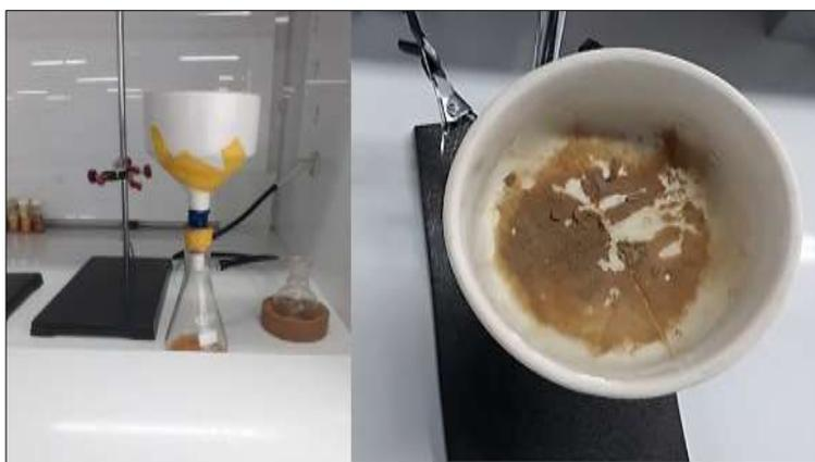
**Figura 19.** Filtración al vacío del biodiesel purificado
