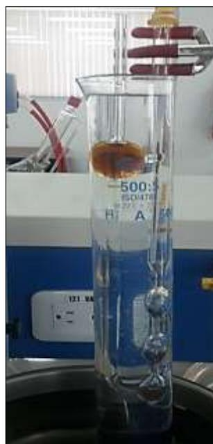
*Figura 21.* Determinación de la viscosidad cinemática del biodiesel a 40°C
