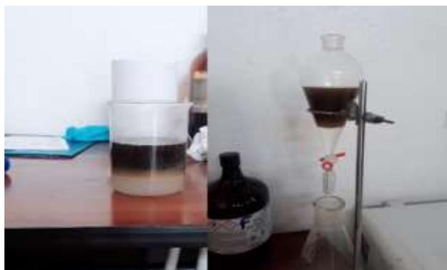
*Figura 15.* Separación del producto hidrolizado
