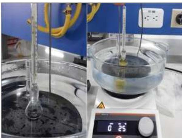
**Figura 10.** Baño termostático en la determinación de la densidad relativa del aceite usado de cocina a 25 °C
