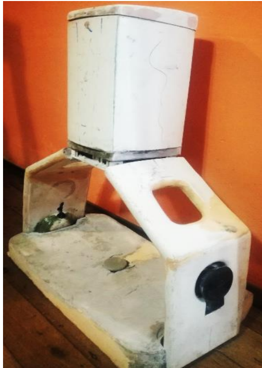
Figura 52. Recubrimiento con fibra de vidrio de los sistemas mecánicos.
