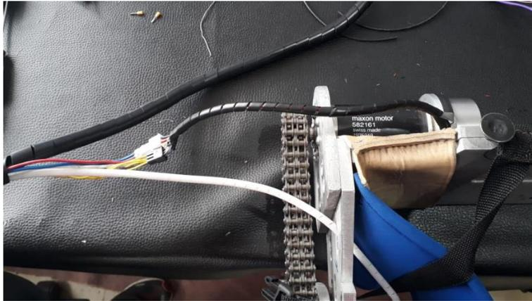
**Figura 64.** Recubrimiento de cables
