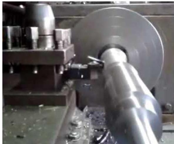
**Figura 54.** Mecanizado de eje
