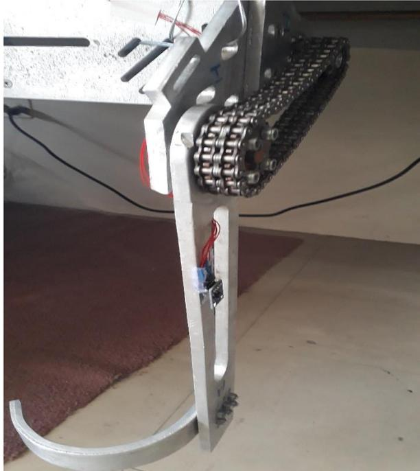
**Figura 62.** Fijación de acelerómetro
