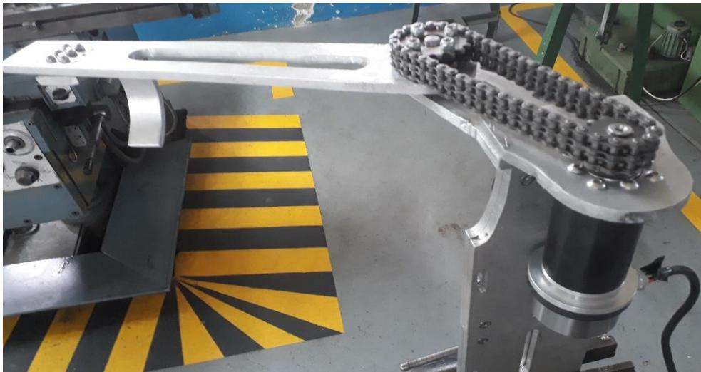
**Figura 61.** Acople de Servomotores y mecanismo de transmisión
