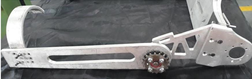
**Figura 60.** Ensamble del arco del muslo y base de motor
