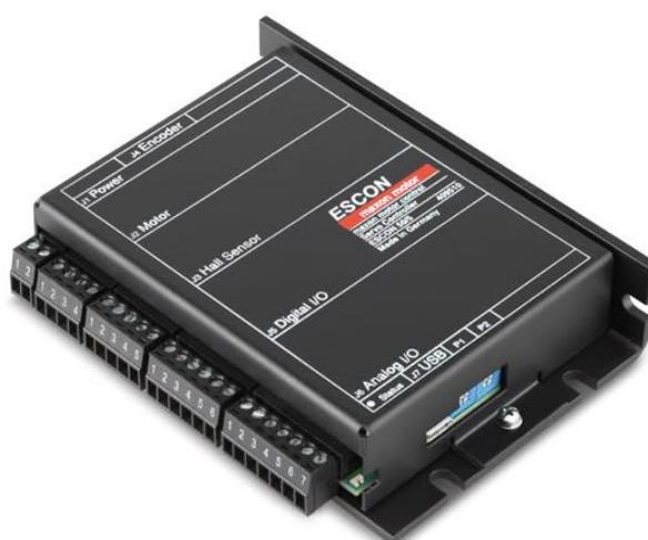
**Figura 46.** Tarjeta Controladora
