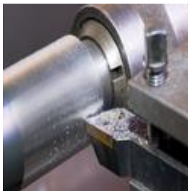
Figura 65. Mecanizado del eje
