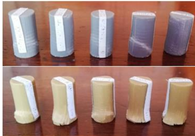
Figura 48. Resultados del ensayo mecánico de compresión
