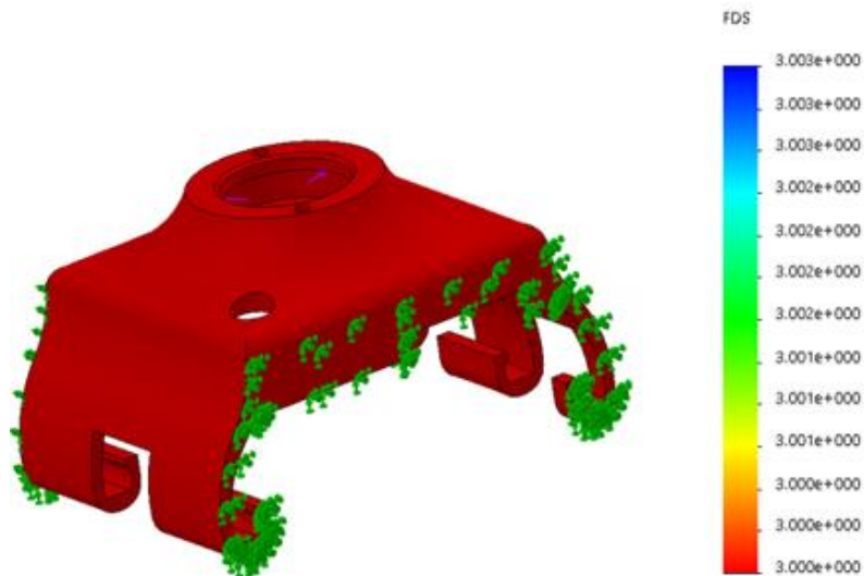
Figura 45. Factor de seguridad del acople
