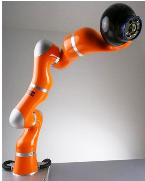
Figura 17. Sistema de visión adaptado a un robot
