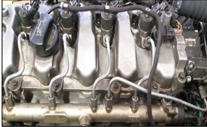
Figura 31. Tuberías de alta presión
