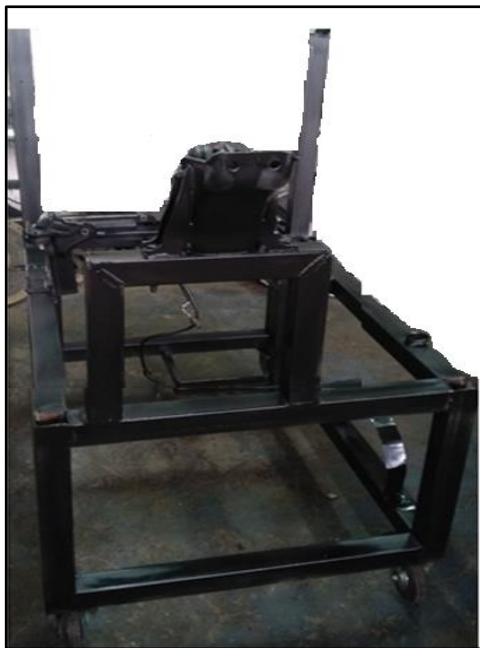
Figura 32. Estructura tubular del banco de pruebas
