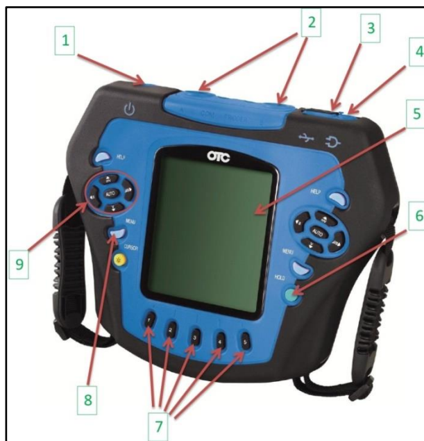
Figura 36. Partes del osciloscopio OTC 3840F
