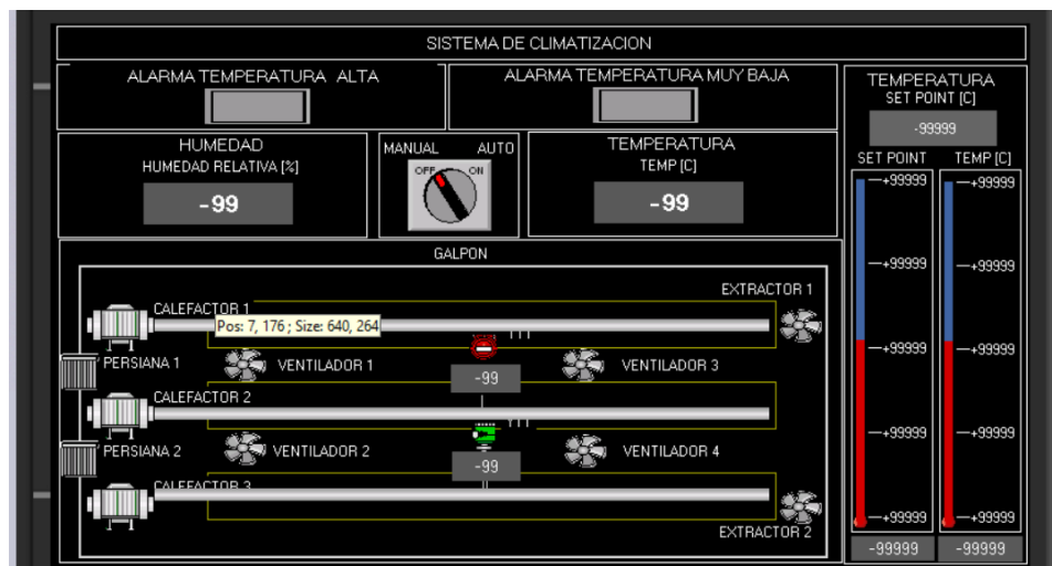
Figura 41. HMI Climatización Modo Auto
