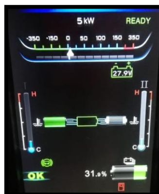
Figura 18. SOC (%) del tablero
