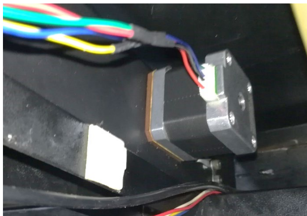
Figura 130. Ensamblaje motor para extrusor
