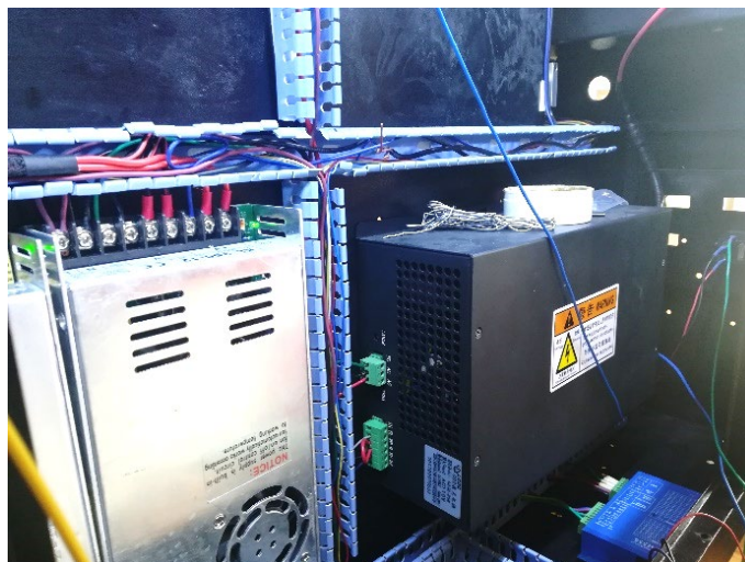
Figura 146. Ensamble fuente tubo láser
