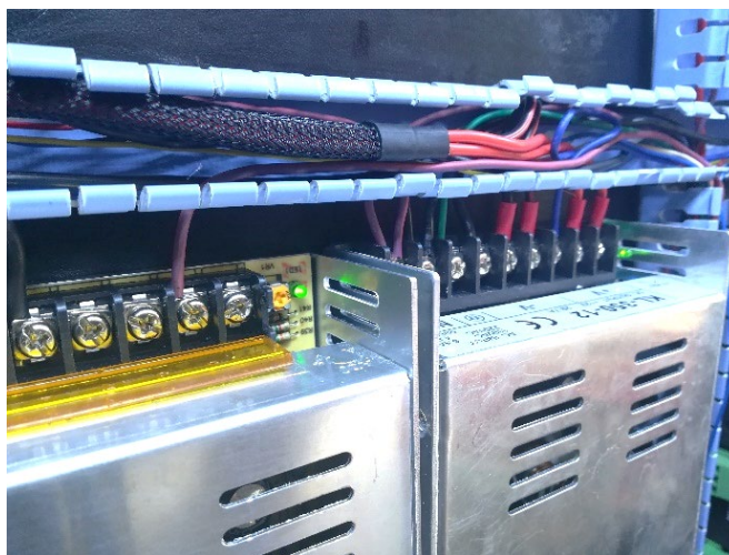
Figura 145. Ensamble fuentes corriente continua
