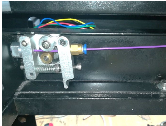
Figura 129. Ensamblaje extrusor tipo bowden
