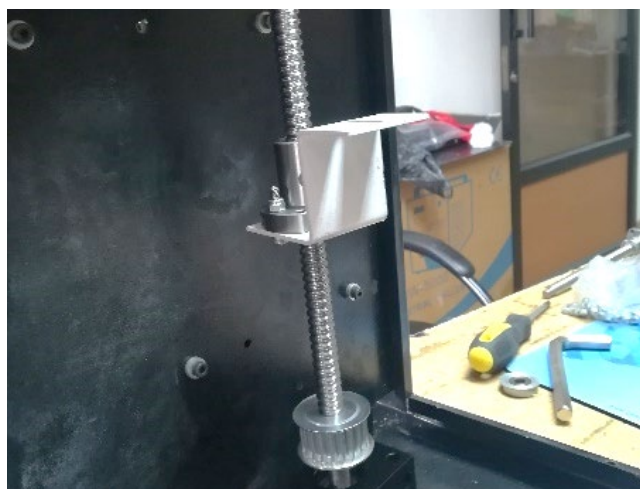
Figura 110. Ensamble mesa sobre pletina
