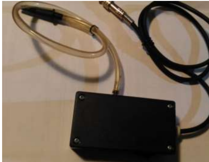
Figura 45. Transductor de presión para osciloscopio
