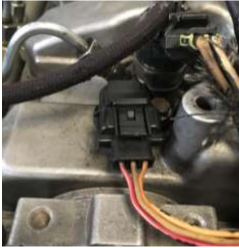
Figura 64. Sensor de posición del árbol de levas CMP
