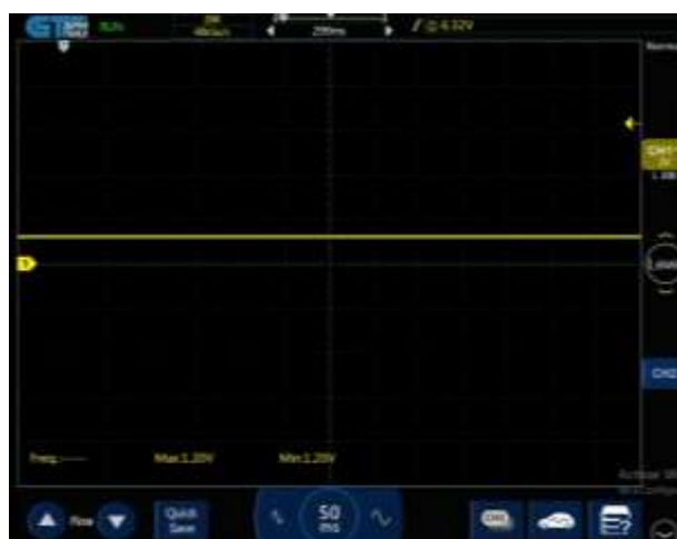
Figura 69. Señal del sensor IAT
