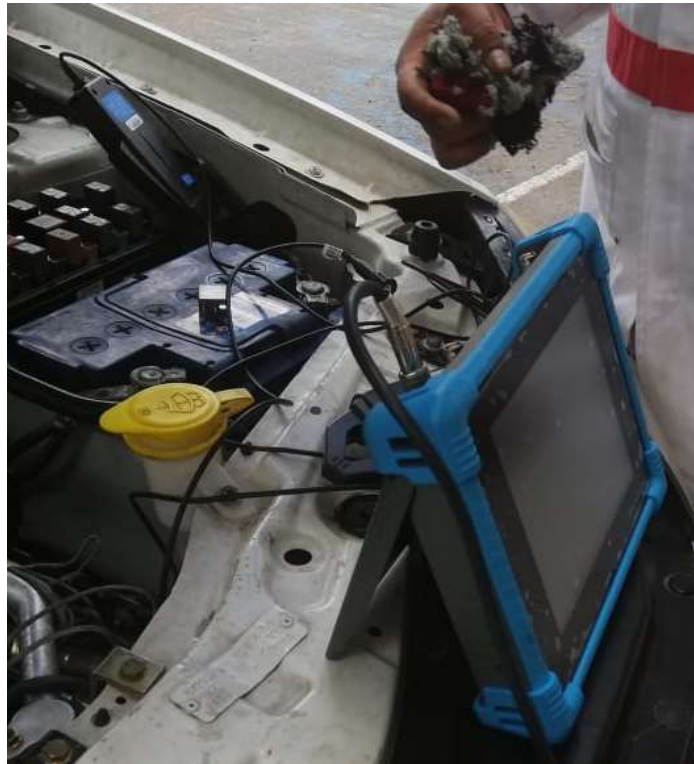
Figura 93. Conexión del Osciloscopio y la punta amperimétrica
