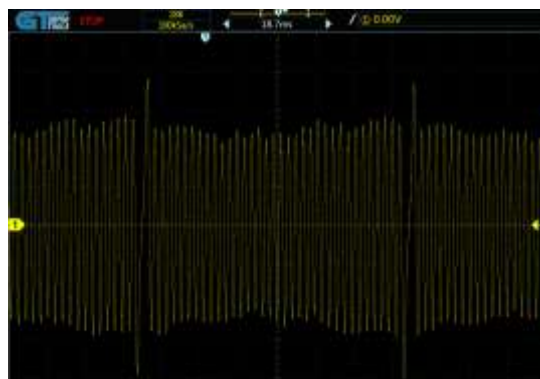
Figura 85. Señal del sensor CKP
