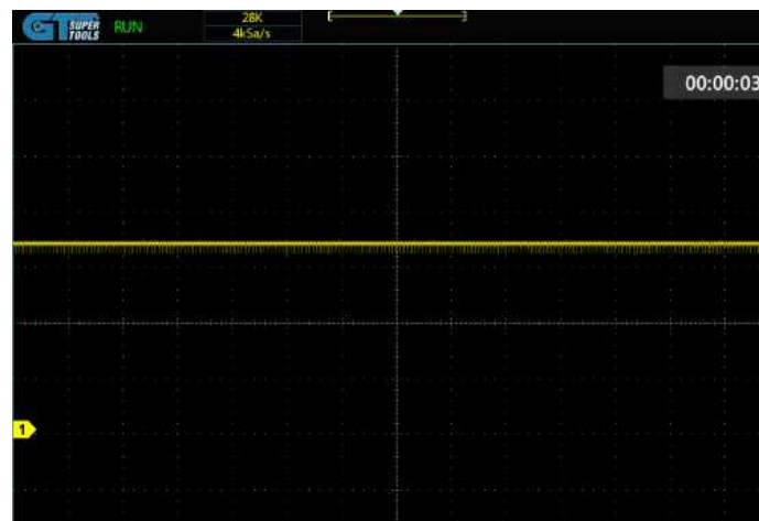
Figura 79. Señal del sensor TPS
