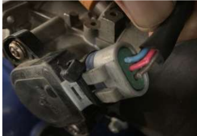
Figura 78. Sensor TPS adaptado a un Nissan Datsun
