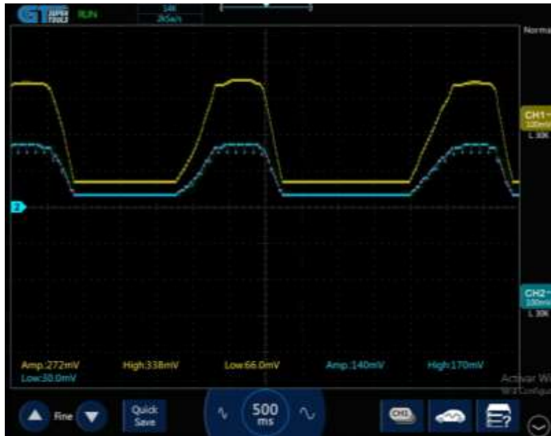
Figura 71. Señal del sensor APP Fuente: Autores
