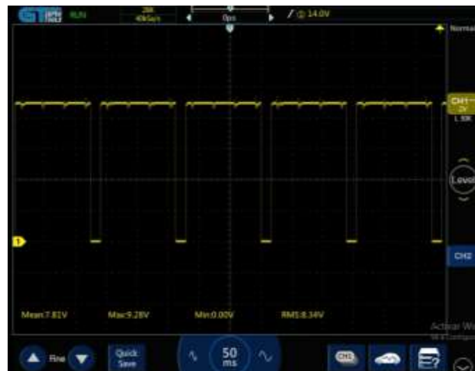
Figura 65. Señal del sensor CMP tomado del pin de señal S1 del banco de pruebas
