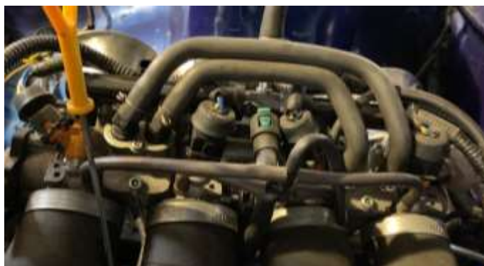
Figura 86. Inyectores acoplados al Nissan Datsun
