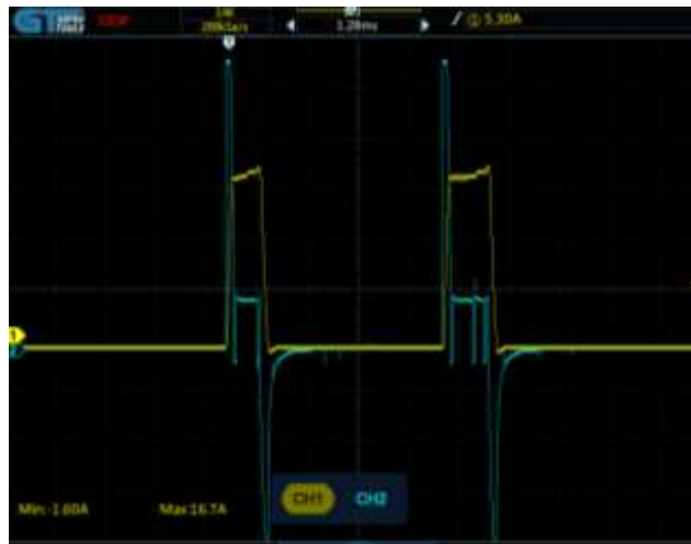
Figura 75. Señal de voltaje y corriente del inyector
