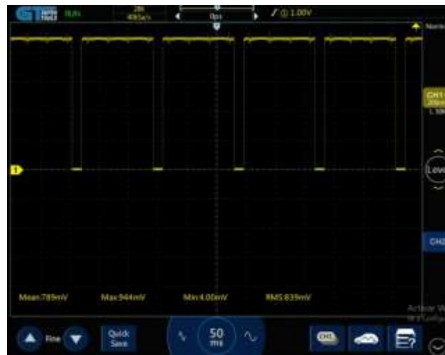
Figura 66. Señal del sensor CMP tomado del pin de señal S2 del banco de pruebas
