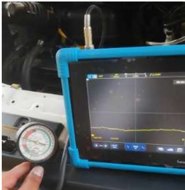
Figura 46. Valores obtenidos mediante un vacuómetro y un transductor de presión
