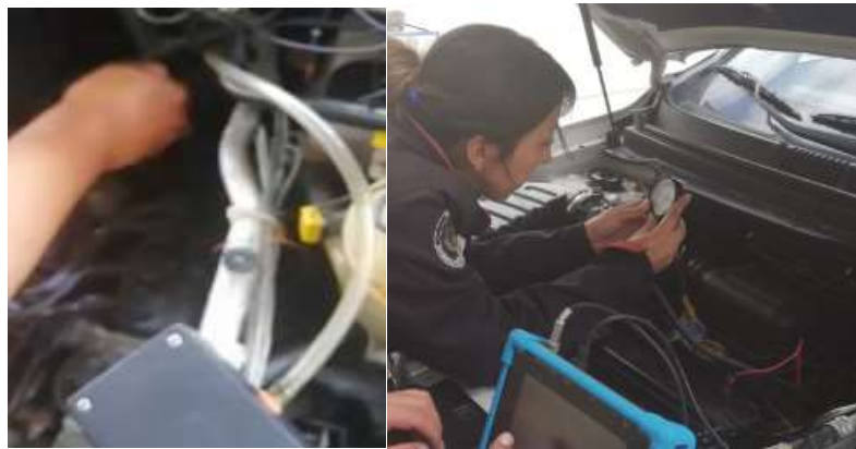
Figura 96. Conexión del traductor de presión y del vacuómetro
