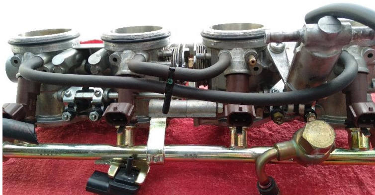
Figura 27. Tomas de vacío en cada estrangulador
