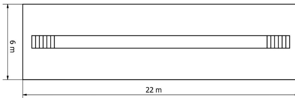
Figura 15. Propuesta de dimensiones para bahía de mantenimiento
