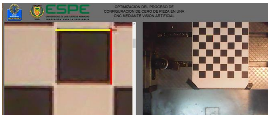
Figura 47. Calibración con el punto de referencia de la máquina CNC
