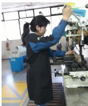
Figura 79. Taladrado de agujeros para la sujeción de la cámara
