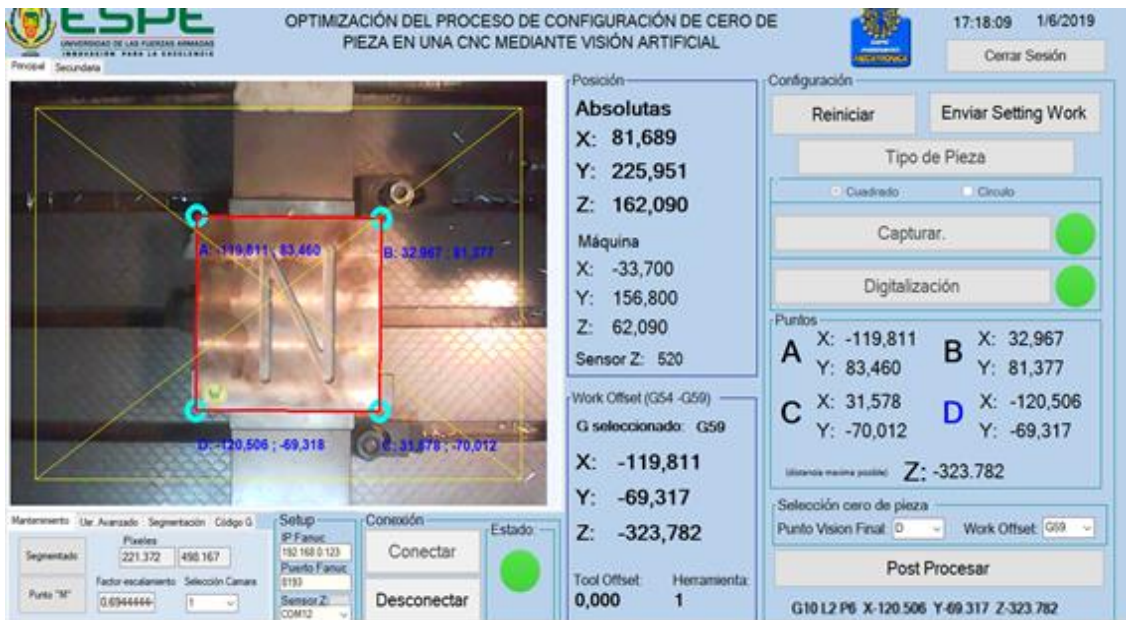
Figura 85. HMI ejecutada con la visualización de coordenadas propias de la visión artificial
