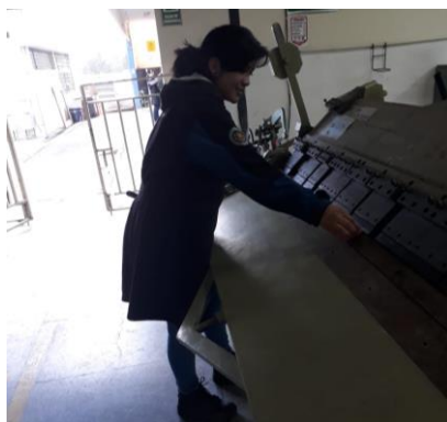
Figura 78. Corte en la cizalla de la placa de tool
