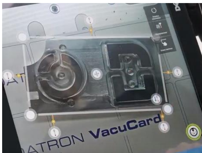
Figura 2. Medición del cero de pieza en una máquina CNC usando la cámara Fuente: (NEO, 2013)
