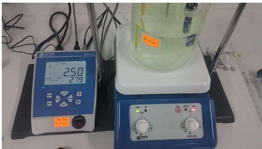
Figura 14. Lixiviado a pH 2.50 y 27.9 °C
