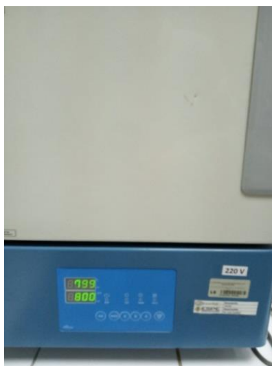
Figura 17. Sólido calcinado en la mufla a 800°C
