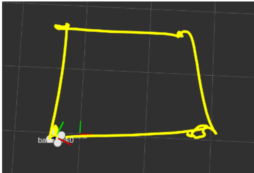
Figura 66. Prueba control PD trayectoria cuadrada desplazamiento en x
