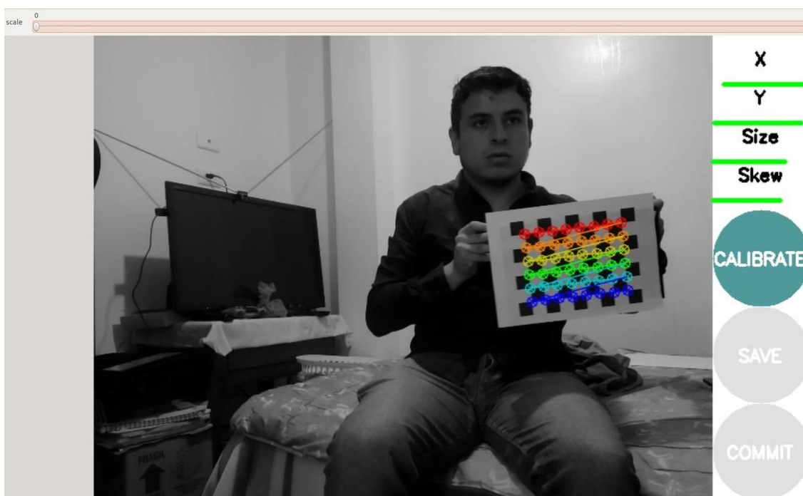
Figura 45. Calibración cámara del dron
