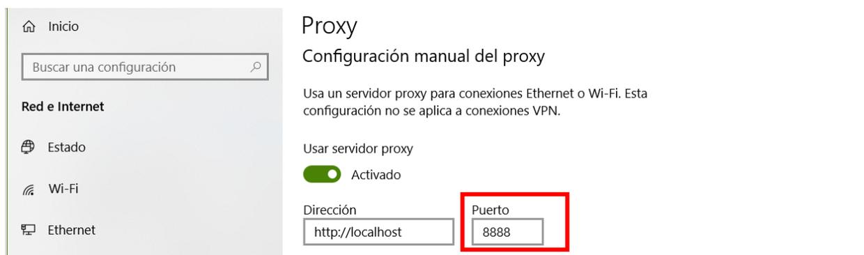
*Figura 137.* Configuración manual de proxy en Windows 10.
