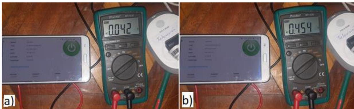
**Figura 118.** Medición de corriente de dispositivo electrónico (alias: Televisor) en estado: a) apagado; b) encendido.
