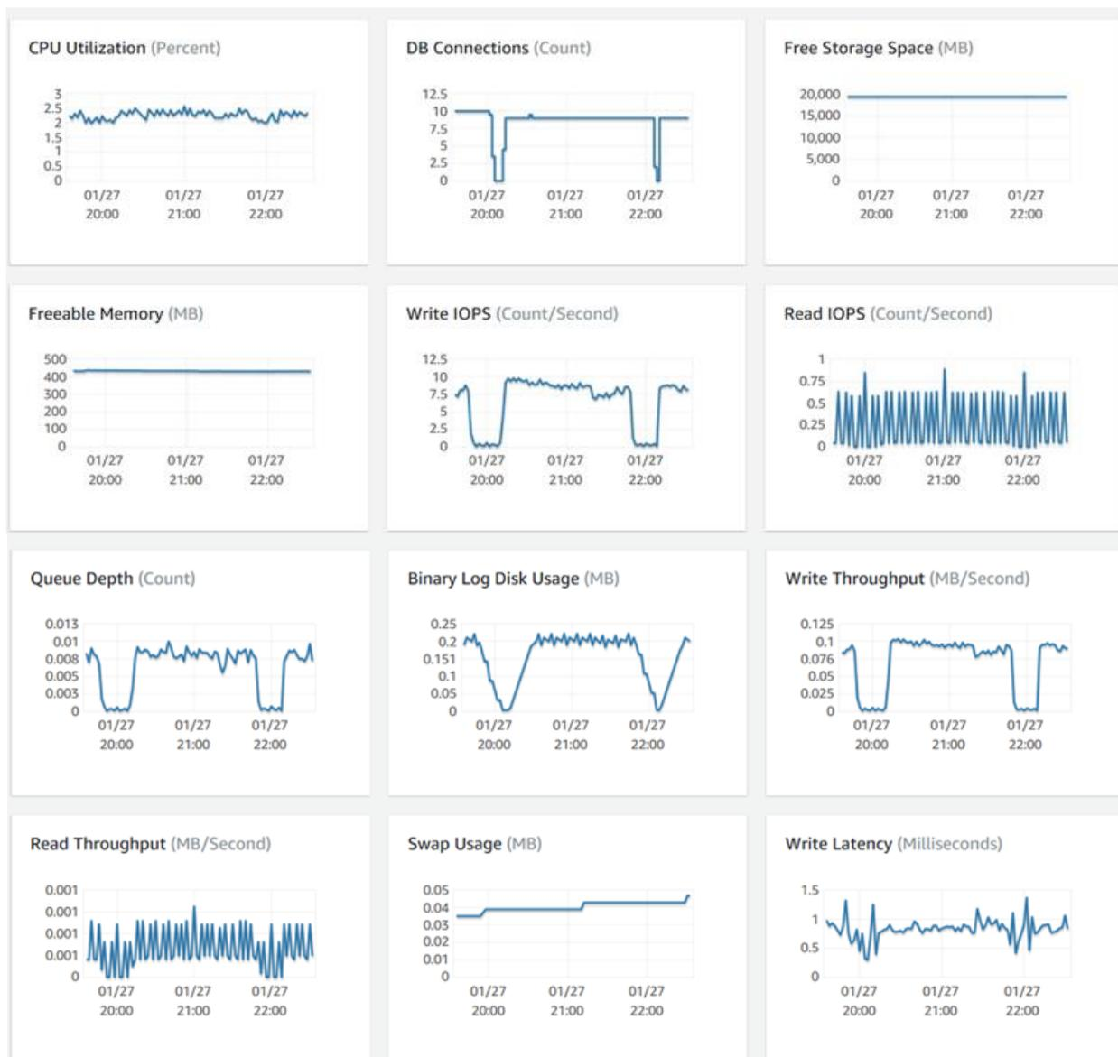
**Figura 124.** Gráficos estadísticos obtenidos mediante CloudWatch para los estados de conexión y desconexión a AWS RDS.
