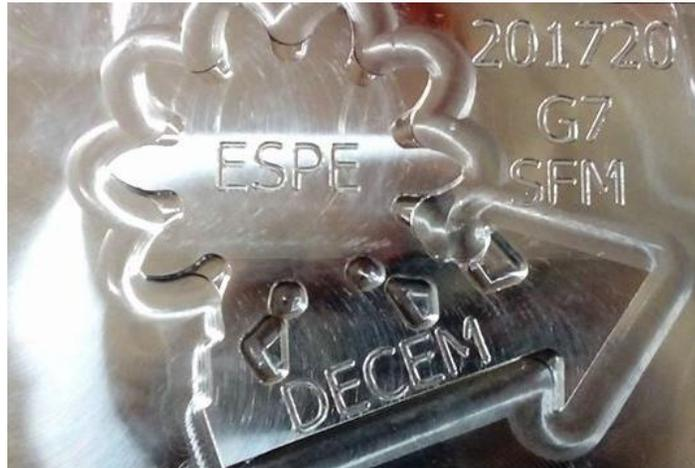
*Figura 5* Fresado HSM en aluminio Prodadx
