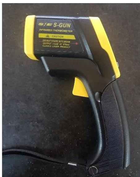
**Figura 36** Pirómetro
