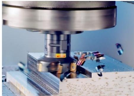
**Figura 4** Operación de fresado
