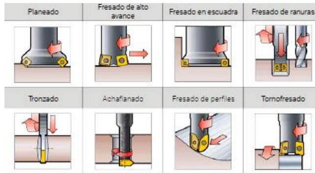
**Figura 8** Distintas operaciones de fresado
