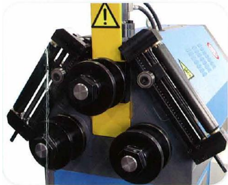
Figura 18 Curvadora piramidal, movimiento hidráulico del rodillo central
