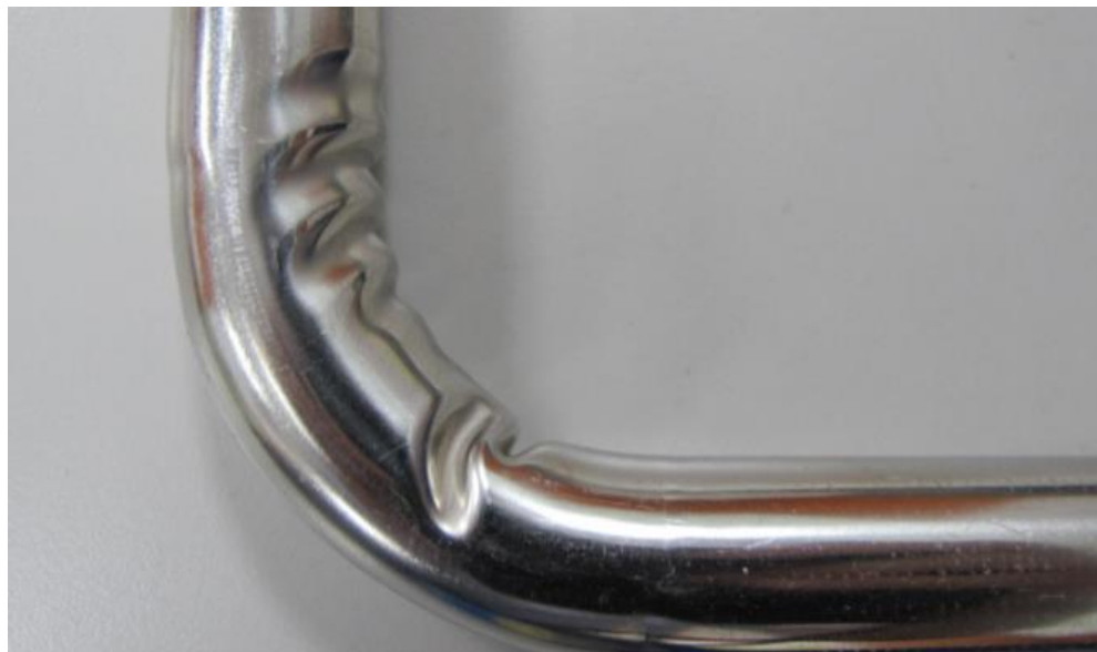
Figura 3 Arrugas generadas en la pared interna de un tubo
