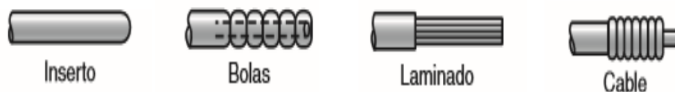
Figura 2. Tipos de mandriles para doblado de tubo Fuente: (Kalpakjian & Schmid, Quinta Edición, pág. 449)
