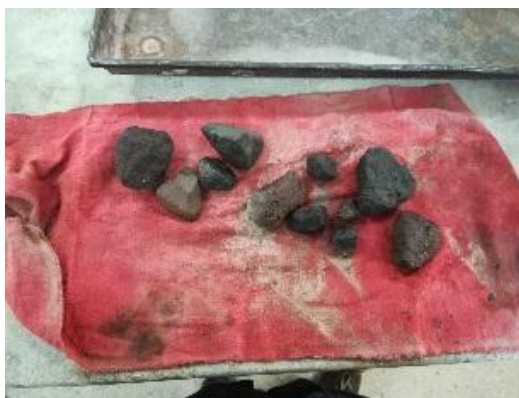
Figura 53. Secado del árido grueso por medio de una franela
