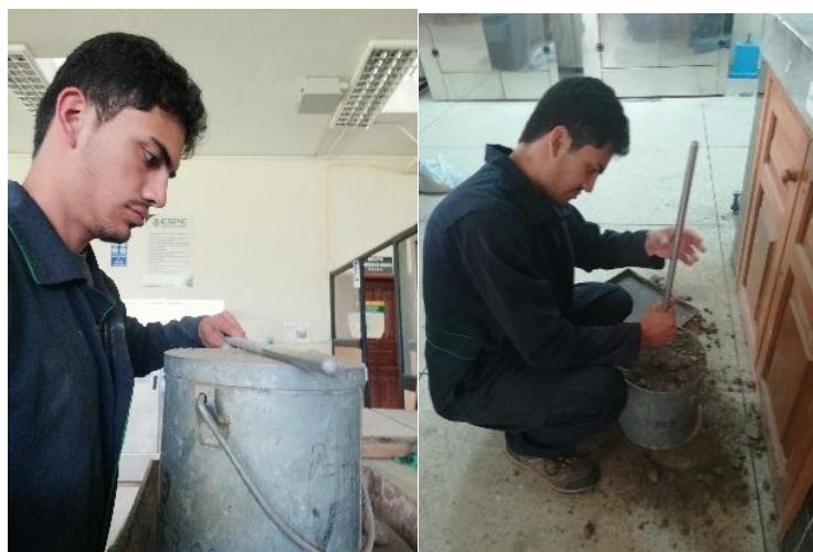
Figura 52. Enrasado de la tercera capa de material
