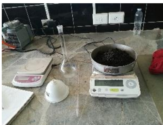
Figura 54. Pesado de la arena en estado SSS
