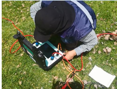
Figura 34. Configuración del sismógrafo para etapa pasiva
