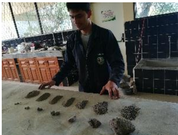
Figura 50. Áridos distribuidos conforme a su granulometría
