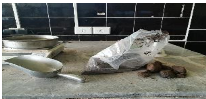
Figura 49. Pesado de muestras para ensayo de humedad
