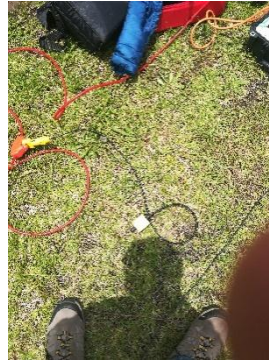
Figura 33. Implantación de geófonos
