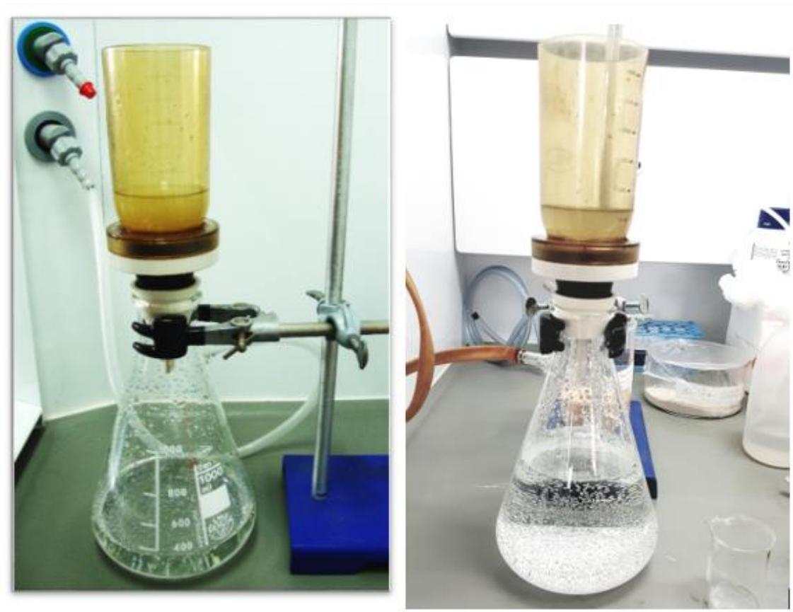
**Figura 28.** Equipo de filtración
