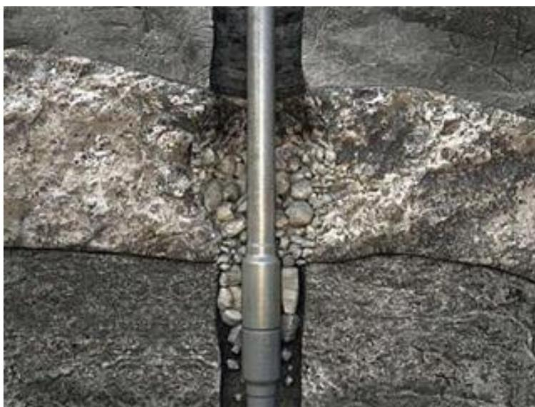
**Figura 4.** Derrumbamiento de pared en perforación
