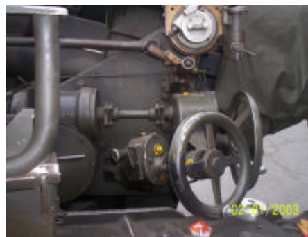
Figura. 2.1. Manivelas del tubo del cañón Autopropulsado de 155mm
