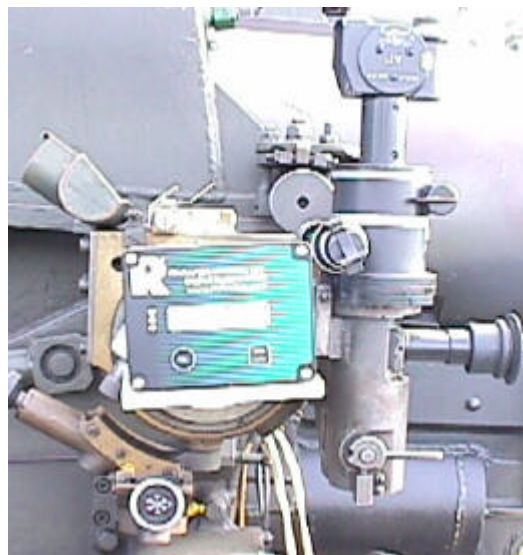
Figura 1.4 Inclinómetro ubicado en el cañón de 155 mm.
