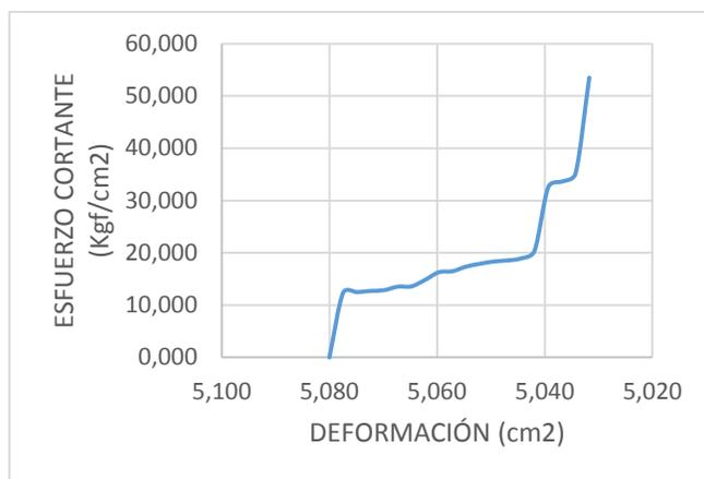
**Figura 145** Curva Esfuerzo vs Deformación en ensayo de compresión de probeta de plástico PLA con 15% de mallado interno
