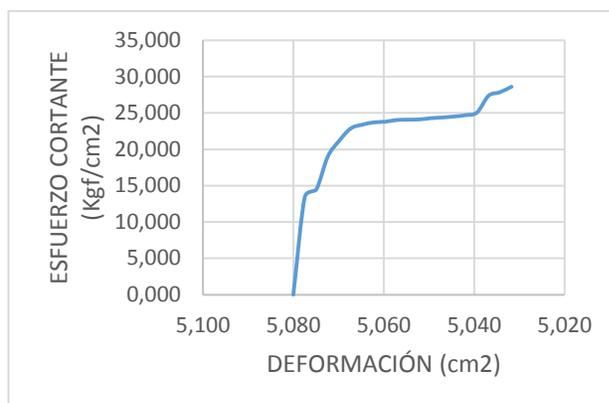
**Figura 143** Curva Esfuerzo vs Deformación en ensayo de compresión de probeta de plástico PLA con 5% de mallado interno
