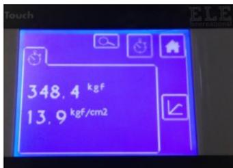
**Figura 144** Máxima carga soportada en compresión por la probeta de plástico ABS con 15% de mallado interno
