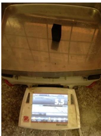
**Figura 131** Peso de probeta en plástico PLA con 5% de espesor de malla
