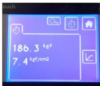
**Figura 142** Máxima carga soportada en compresión por la probeta de plástico ABS con 5% de mallado interno
