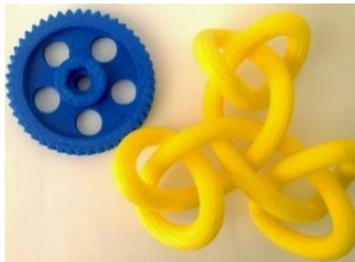
**Figura 17** Rueda dentada y estructura impresas en plástico PLA
