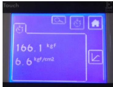
**Figura 140** Máxima carga soportada en compresión por la probeta de plástico PLA con 15% de mallado interno
