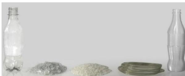
**Figura 23** Plástico PET triturado, convertido en filamento e impresión 3D
