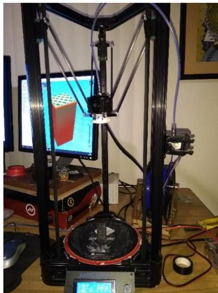
**Figura 127** Impresión 3D y de probeta 4 en plástico PLA
