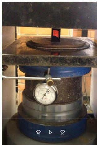
**Figura 134** Ensayo con probeta PLA 15% de mallado interior
