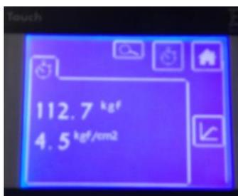
**Figura 138** Máxima carga soportada en compresión por la probeta de plástico PLA con 5% de mallado interno
