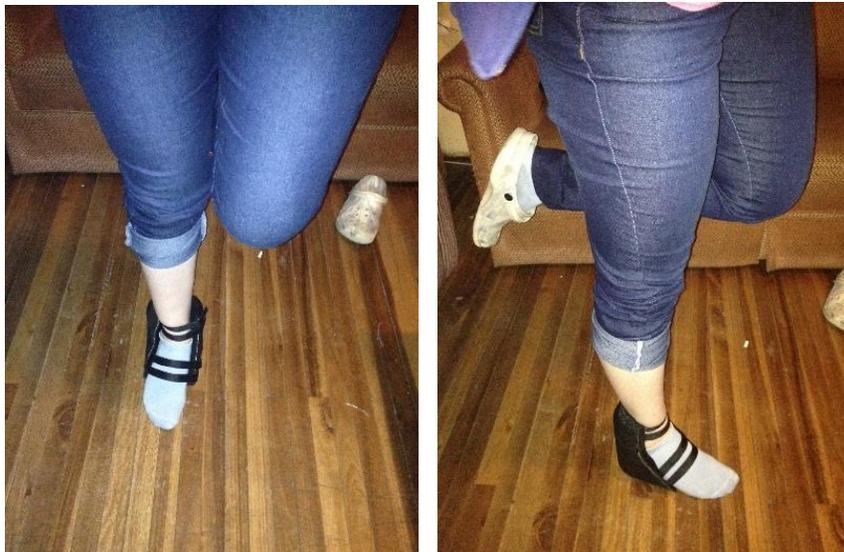
**Figura 176 y 177** Prueba de soporte de carga de 620N en el prototipo de órtesis.
