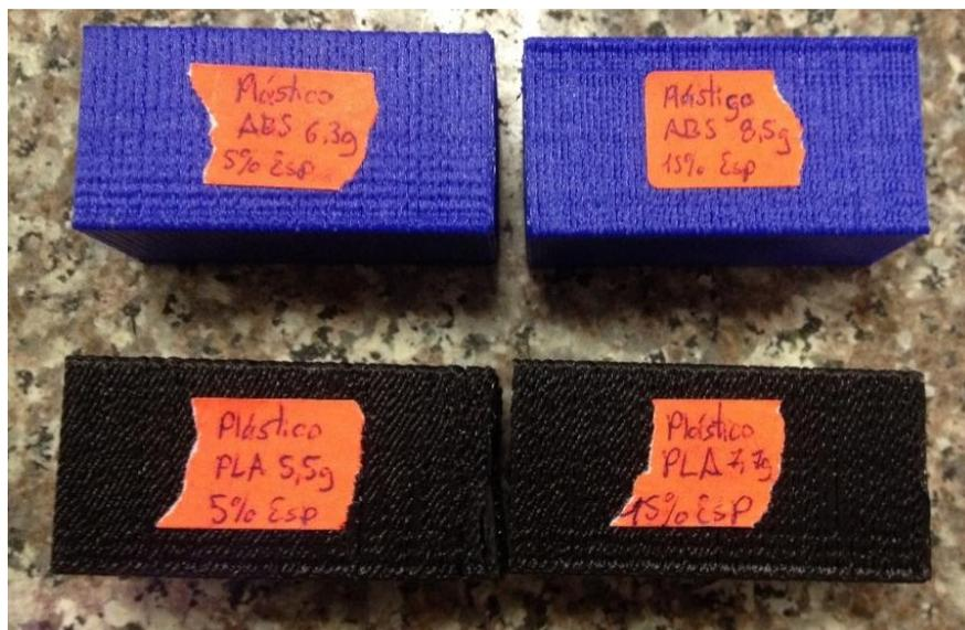
**Figura 132** Probetas con sus características de mallado interno, tipo y peso
