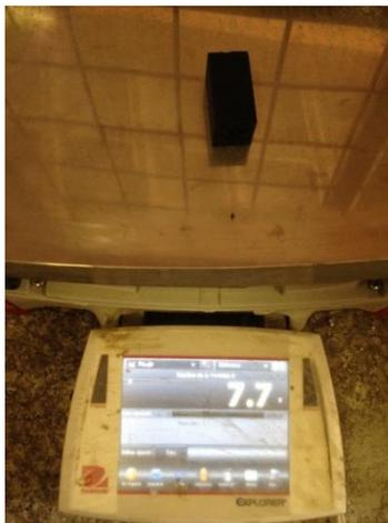
**Figura 130** Peso de probeta en plástico PLA con 15% de espesor de malla
