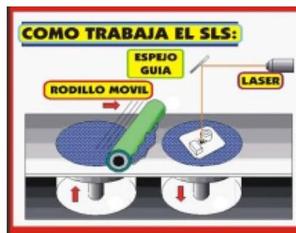
**Figura 14** Sinterización por láser.
