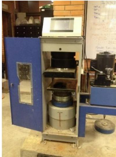
**Figura 107** Máquina de ensayo a compresión marca ACCU-TEK touch 350
