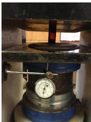
**Figura 136** Ensayo con probeta ABS 15% de mallado interior
