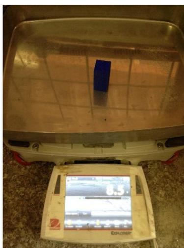
**Figura 128** Peso de probeta en plástico ABS con 15% de espesor de malla
