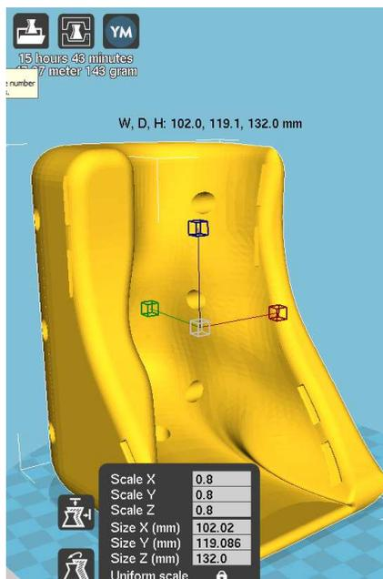
**Figura 170** Reducción de escala, tiempo de impresión y cantidad de material ABS necesario
