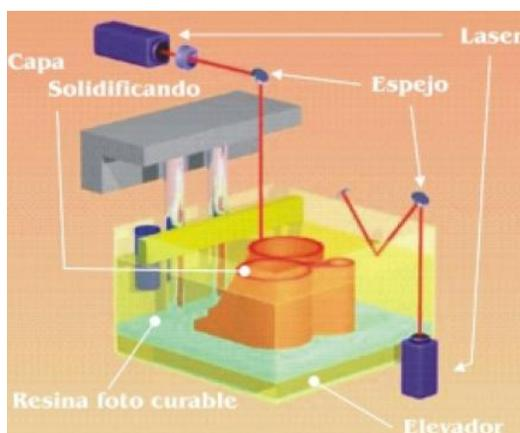
**Figura 12** Estereolitografía
