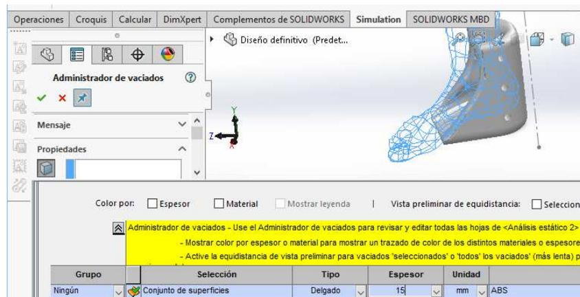
**Figura 91** Configuración del espesor de vaciado en 15mm
