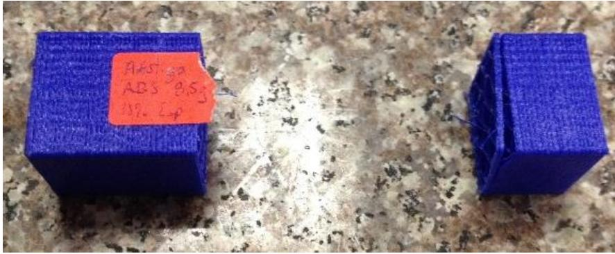
**Figura 137** Probeta fracturada en ensayo de compresión
