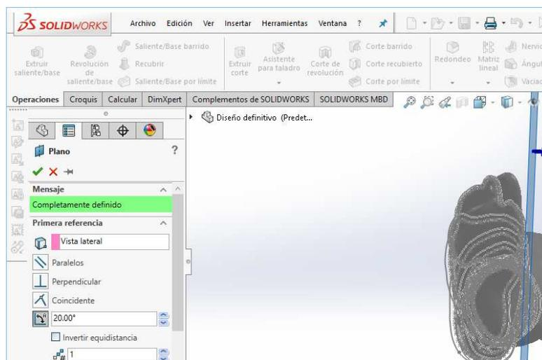
**Figura 68** Creación de plano rotado  $20^\circ$  con referencia del plano lateral
