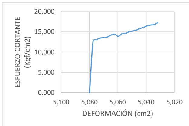
**Figura 139** Curva Esfuerzo vs Deformación en ensayo de compresión de probeta de plástico PLA con 5% de mallado interno
