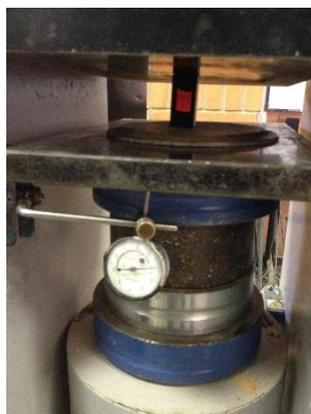
**Figura 135** Ensayo con probeta ABS 5% de mallado interior
