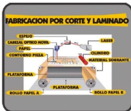
**Figura 15** Corte láser y laminado.
