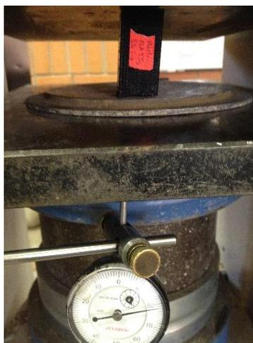
**Figura 133** Ensayo con probeta PLA 5% de mallado interior
