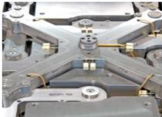
Figura 27. Molde con canales de colada calentada Fuente: (IPROMARC, 2018)
