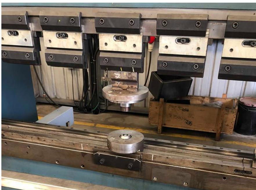
**Figura 1.** Máquina dobladora incorporado un sistema de punzonado.
