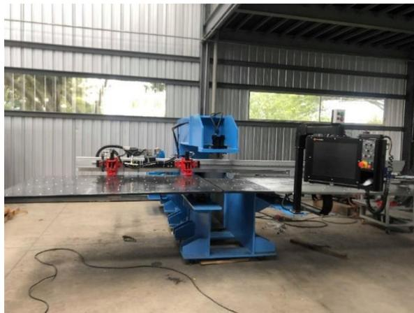
**Figura 64.** Instalación de la computadora de control
