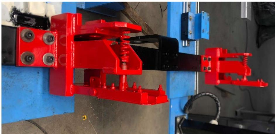
**Figura 58.** Construcción e instalación de las pinzas de sujeción
