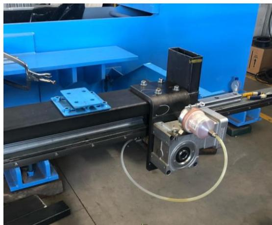
**Figura 53.** Instalación de los servomotores con sus reductores
