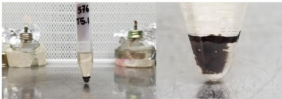
**Figura 12.** Medición de volumen de células sedimentadas
