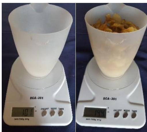
Figura 12 Obtención experimental de densidad de producto
