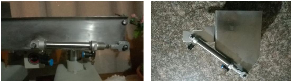
Figura 39 Montaje de pistones en Canal y Tolva de Dosificación
