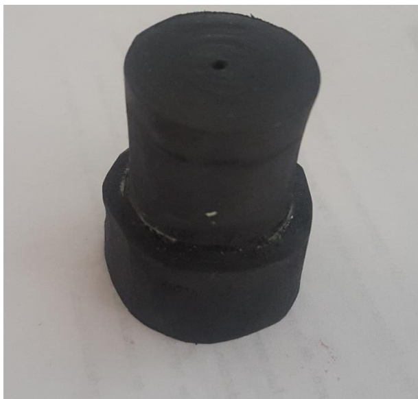
Figura 19 Disco flexible para soporte de canales vibratorios
