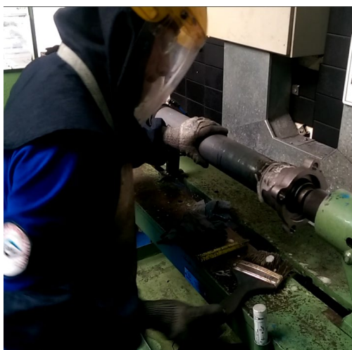
Figura 1. Mesa de prueba de estanqueidad
