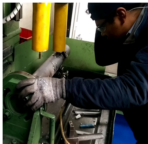
Figura 2. Taladro Leland perforado y roscado
