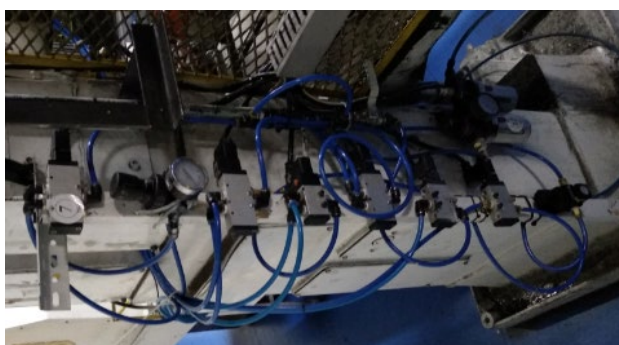
Figura 111. Sistema neumático taladro Leland
