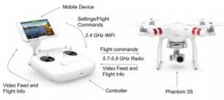
**Figura 5** Vista general del sistema Dron.
