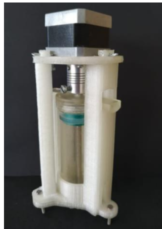
Figura 30. Extrusor de la impresora armado
