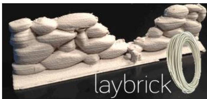
Figura 12. Material Laybrick para impresión 3D Fuente: (Iniciativas 3D, 2019)
