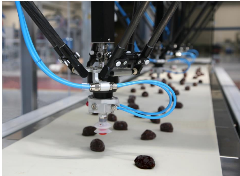
Figura 18. Robots tipo delta en la industria Fuente: (Cama 1 S.p.A., 2016)
