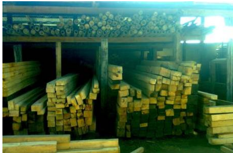
Figura 13. Vigas aserradas de Chanul.
