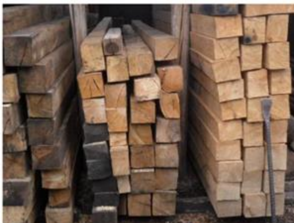
Figura 9. Pilares de colorado.
