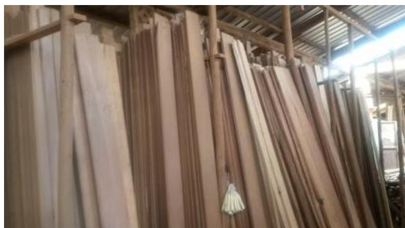
Figura 18. Duelas de madera apiladas verticalmente.
