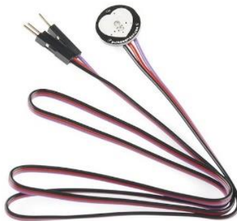
Figura 4. Sensor de pulso de ritmo cardíaco Fuente: (Mbientlab, 2017)
