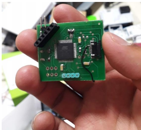
Figura 27. Placa base del prototipo de pulsera inteligente
