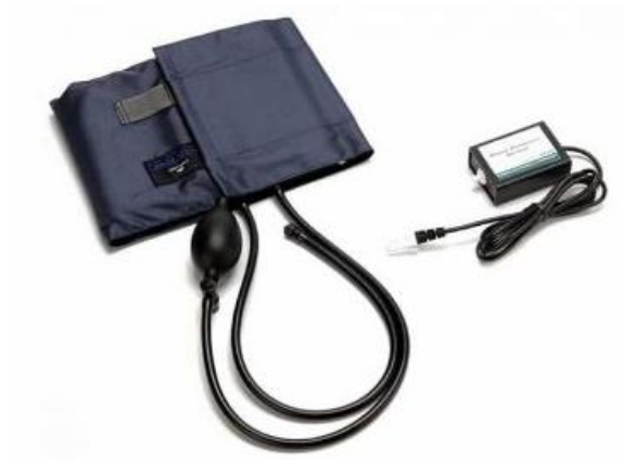
Figura 16. Sensor de presión arterial Fuente: (Villanueva, 2017)
