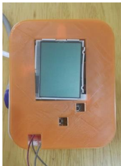
Figura 45. Impresión 3D de la estructura del tensiómetro
