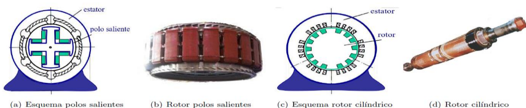
Figura 2. Formas Constructivas de Generadores Síncronos más Comunes
