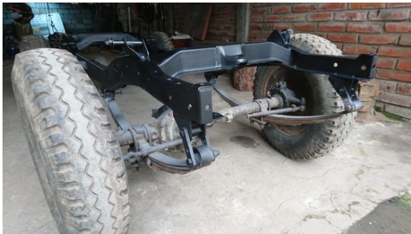
Figura 72. Ensamble y pintura del bastidor
