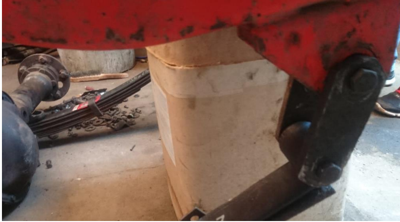
Figura 69. Ajuste de ballestas
