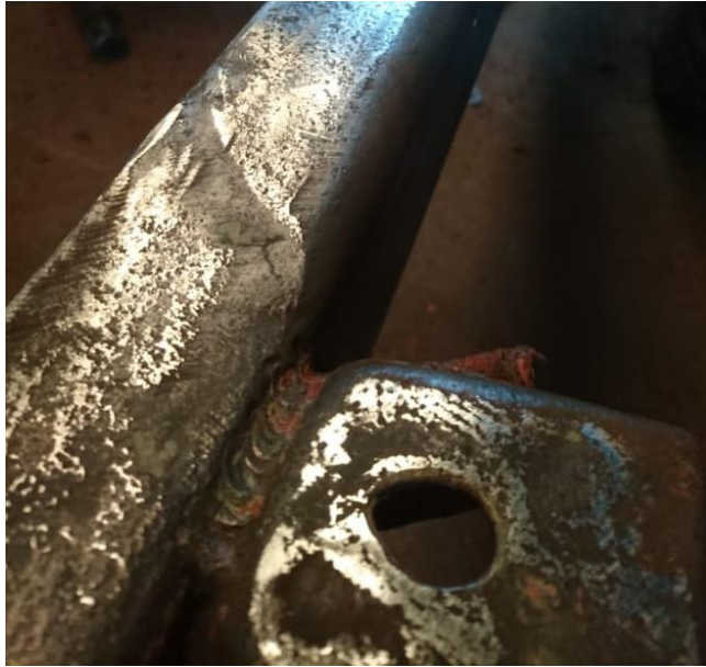
Figura 71. Soldadura de apoyos carrocería
