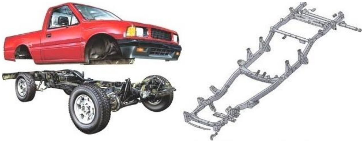
Figura 6. Chasis independiente para un Todo Terreno.
