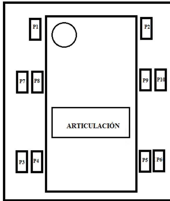
**Figura 44.** Disposición (b) neumáticos del bus K11A
