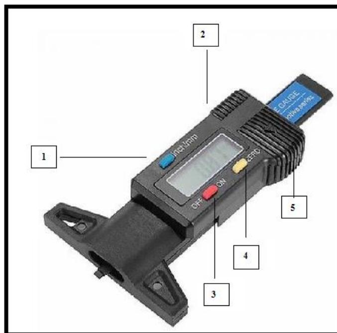
**Figura 45.** Partes del medidor de profundidad
