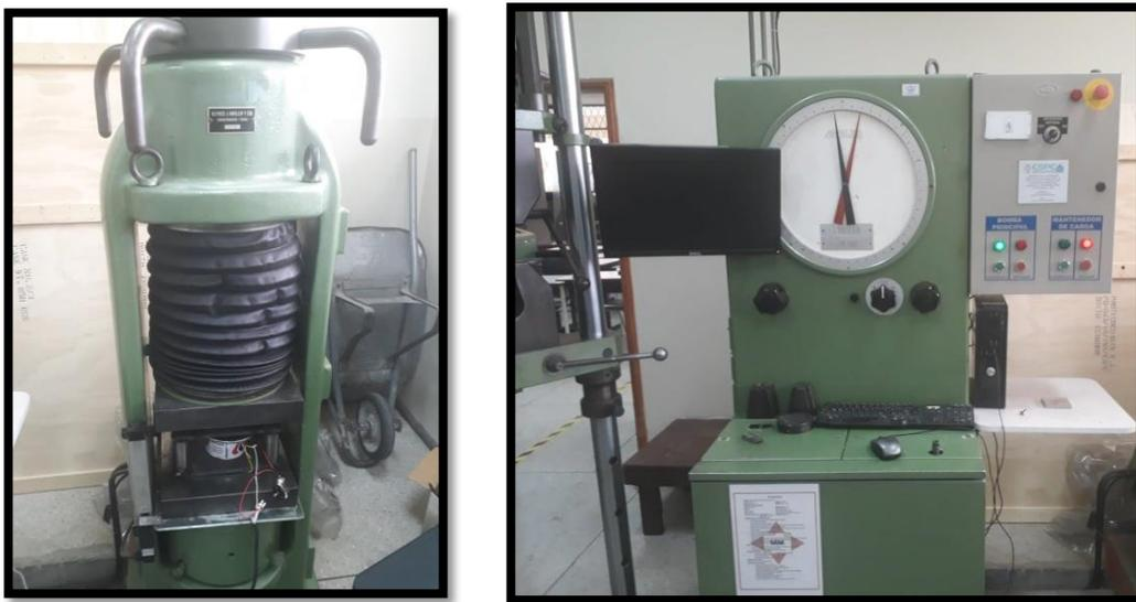
**Figura 48.** Máquina de compresión y controles
