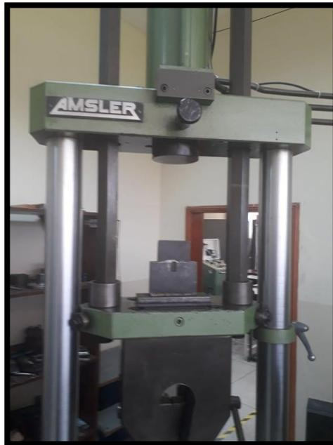
**Figura 58.** Ensayo de resistencia interna al corte
