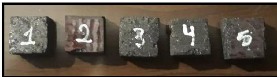
**Figura 57.** Probetas para el ensayo de resistencia interna al corte.**4.4.2. Cálculo del área de la sección transversal**
