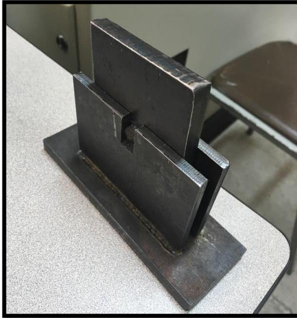
**Figura 51.** Accesorios ensayo resistencia al corte
