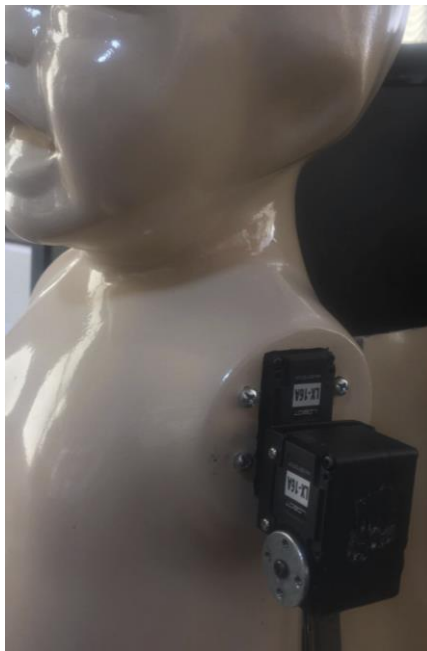
Figura 47. Ensamble del segundo grado de libertad.
