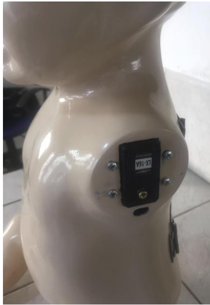
Figura 46. Ensamble del primer grado de libertad.
