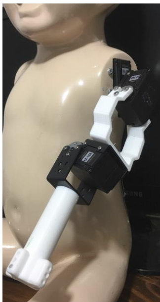
Figura 50. Ensamble eslabón antebrazo.
