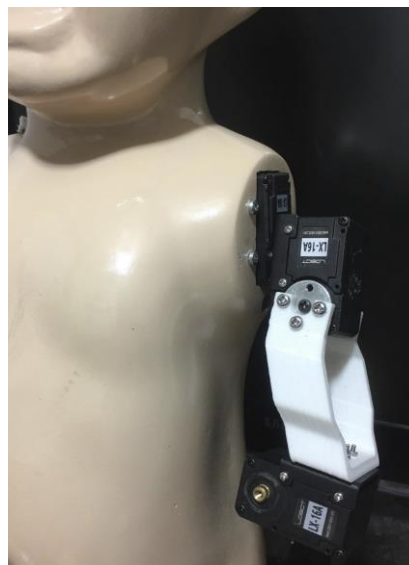
Figura 49. Ensamble del tercer grado de libertad.
