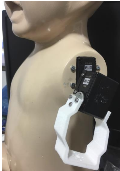
Figura 48. Ensamble eslabón brazo.
