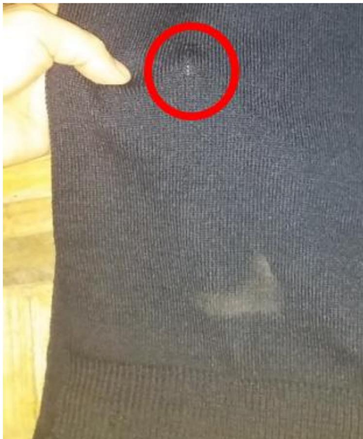
Las 20 primeras pruebas fueron realizadas en altos de manga talla 40, mientras que las 20 segundas en altos de cuerpo talla 40. De las pruebas de detección de orificios se puede concluir que detectó erróneamente tres veces, en el borde derecho.
