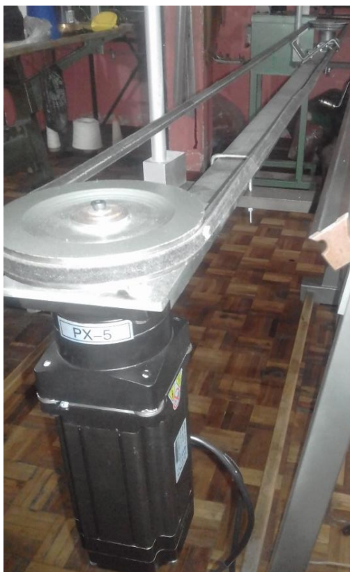
Figura 77 Implementación de la transmisión del carro en la máquina
