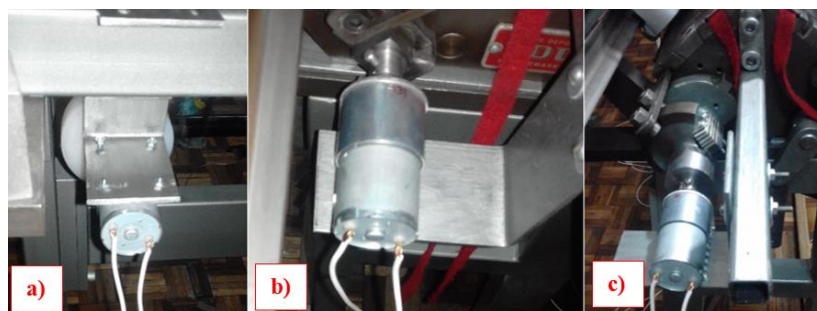
Figura 82 Mecanismos implementados fuera del carro: a) activación de mecanismo de rodillo, b) activación de mecanismo de cama frontal y c) activación de mecanismo de cama posterior.
