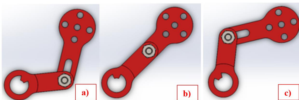
Figura 45 Las 3 posiciones del mecanismo de selección de agujas: a) 38^\circ , b) 0^\circ y c) -38^\circ .
