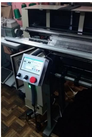
Figura 87 Ubicación del panel de control
