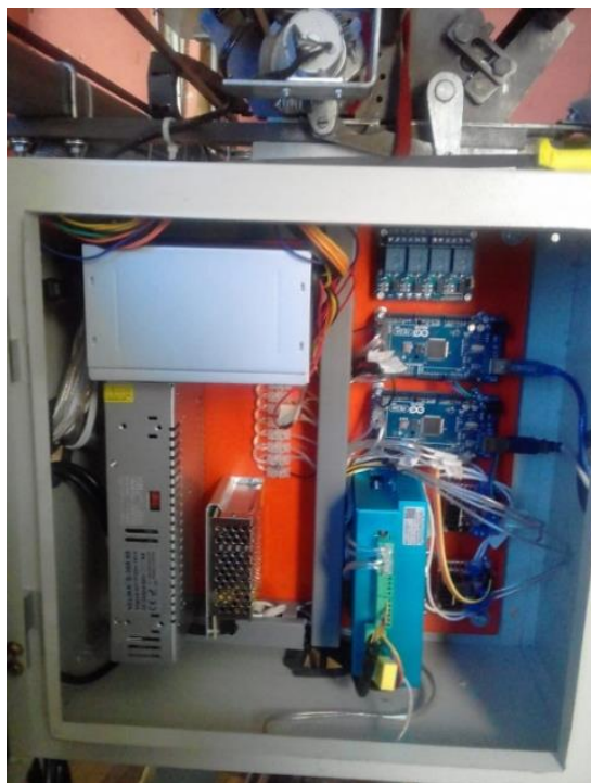
Figura 89 Distribución de elementos en el armario
