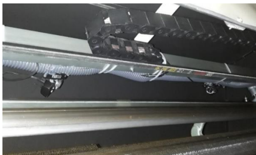
Figura 92 Ubicación de cámaras para el módulo de control de calidad por visión artificial.
