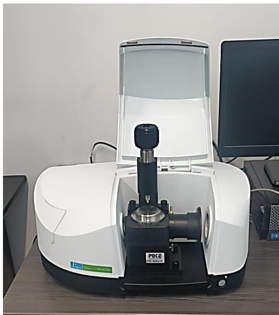
Figura 9. Espectrofotómetro infrarrojo de transformada de Fourier (PerkinElmer – Spectrum Two)
