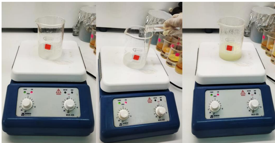
Figura 14. Elaboración de tensoactivo a partir de éster metílico de aceite de ricino.
