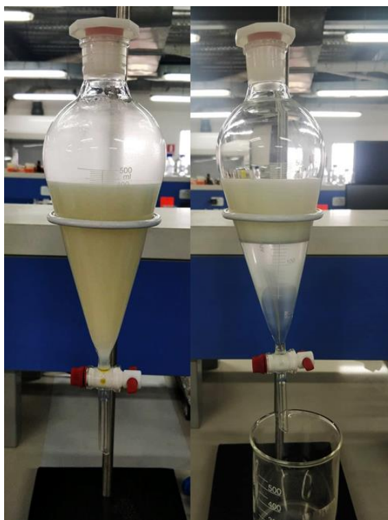
Figura 12. Lavado de éster metílico
