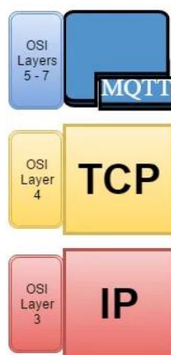
Figura 5. MQTT en modelo OSI
