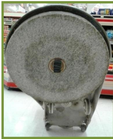
*Figura 35* Disco de abrillantadora industrial
