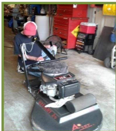
*Figura 23* Técnico examinando maquina sin protección
