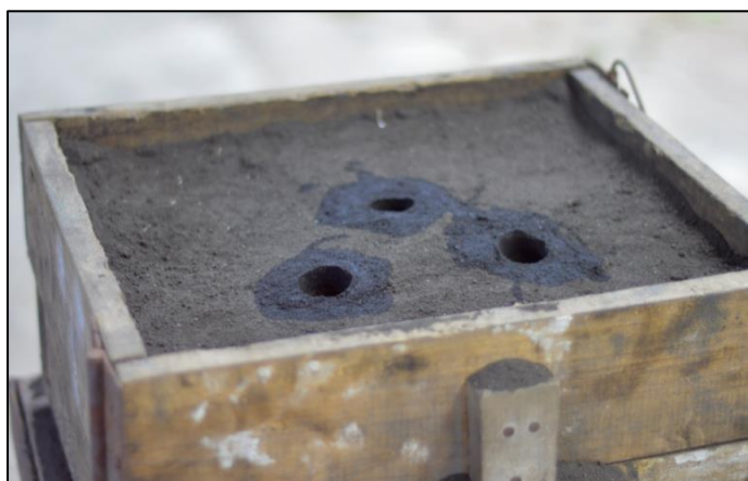
Figura 20: Molde de arena para fundición, con respiraderos.
