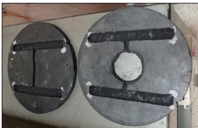
Figura 18: Discos de silicona para proceso de fundición centrífuga.
