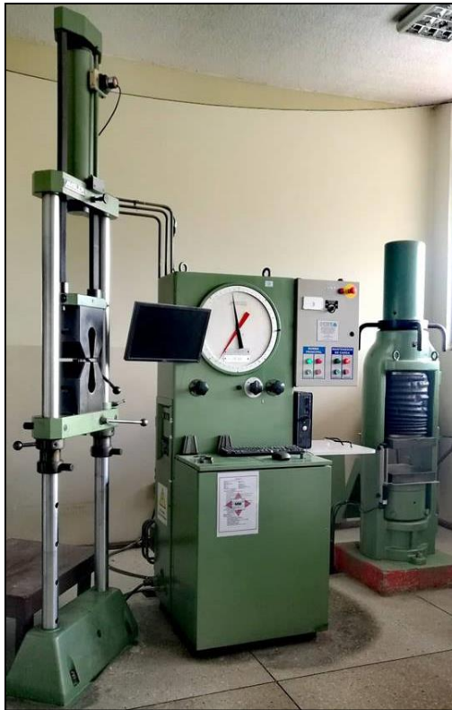
Figura 30: Máquina de ensayos universales MTS TK/T5002 - ensayo de tensión
