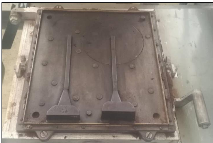
Figura 17: Molde de acero fabricado para maquina Polygram, proceso de fundición en cáscara.
