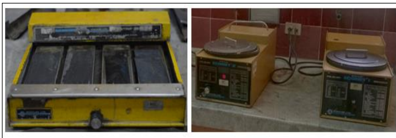
Figura 28: Maquinas utilizadas para preparación de probetas, lijado y pulido respectivamente.
