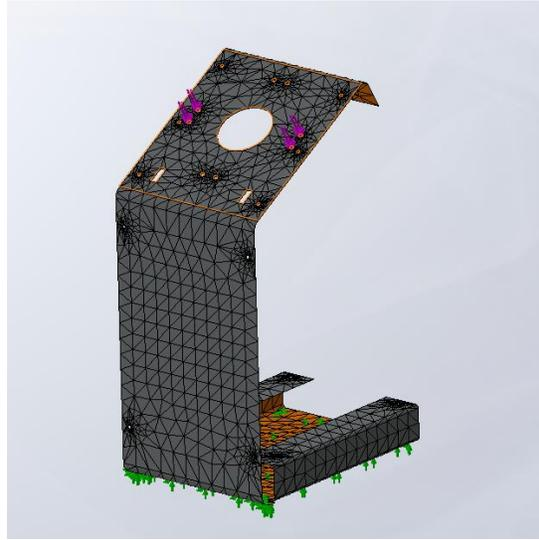
**Figura 28.** Condiciones de frontera de la base. Las flechas verdes indican los puntos de apoyo y las flechas moradas los puntos donde tendrán efecto las cargas.
