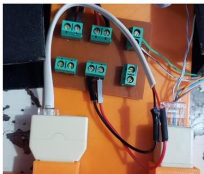
**Figura 43.** Conexiones RJ45 y RJ11 para datos y fuente respectivamente.
