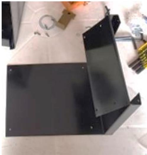
**Figura 33.** Pieza mecanizada, doblada y pintada.
