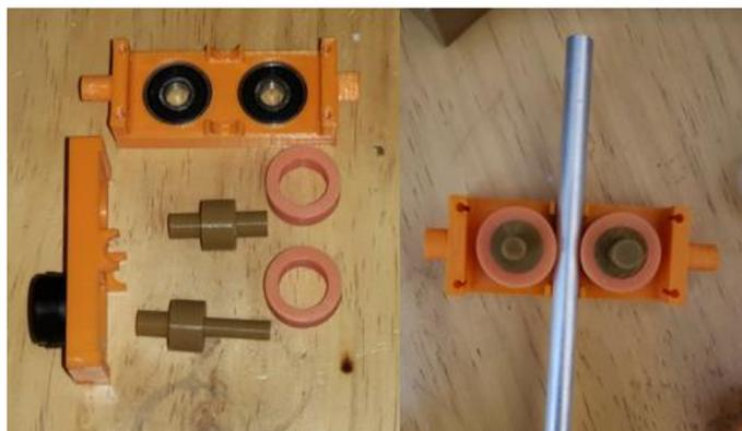
**Figura 39.** Elementos y montaje del mecanismo de medición del eje “Z”.
