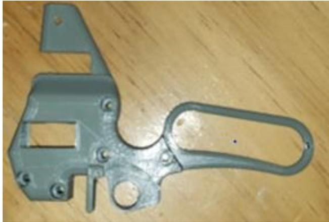
**Figura 35.** Pieza (1) de la pinza impresa en 3D.
