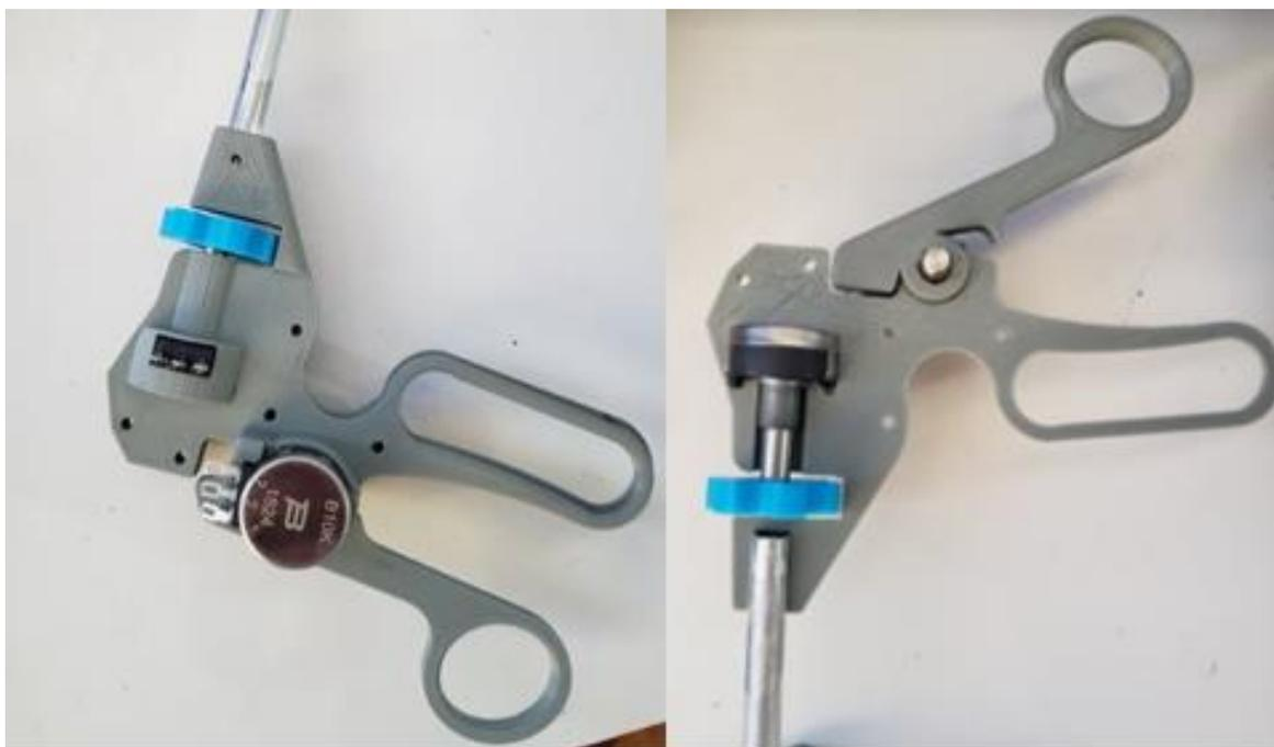
**Figura 37.** Ensamble de la pinza, ubicación de los potenciómetros en la pieza (2).
