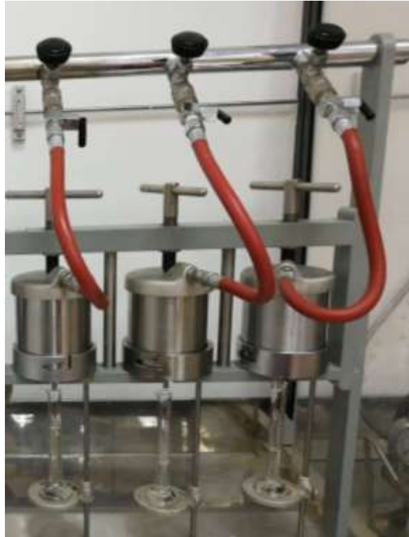
Figura 2. Celdas de filtración API
