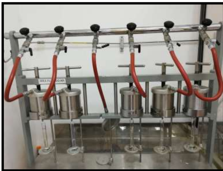
Figura 14. Equipo de filtración API.
