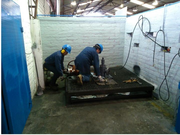
**Figura 2.** Realización de pruebas de presión en la actualidad.
