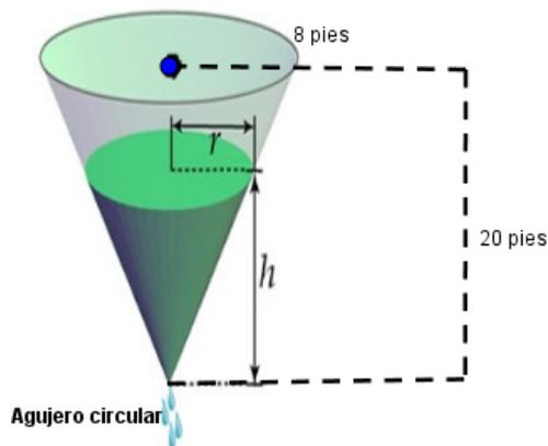
Figura 38. Drenado de un cono invertido. Zill (s.f.)
