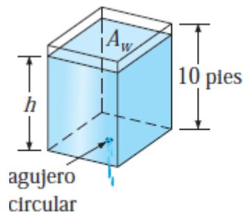
Figura 37. Drenado de un tanque. Zill (s. f.)
