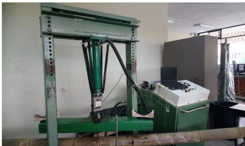
**Figura 54.** Vibroforo de baja frecuencia AMSLER-417 U con capacidad de 100 Tn
