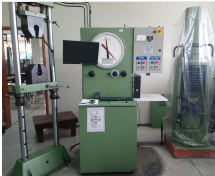
**Figura 45.** Máquina de ensayos universal AMSLER FM-1033
