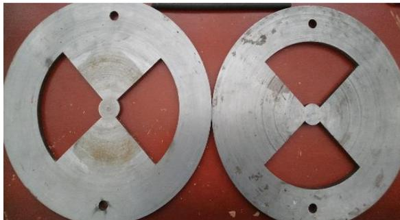
**Figura 73.** Placa especial de cizallamiento o corte (configuración mariposa)
