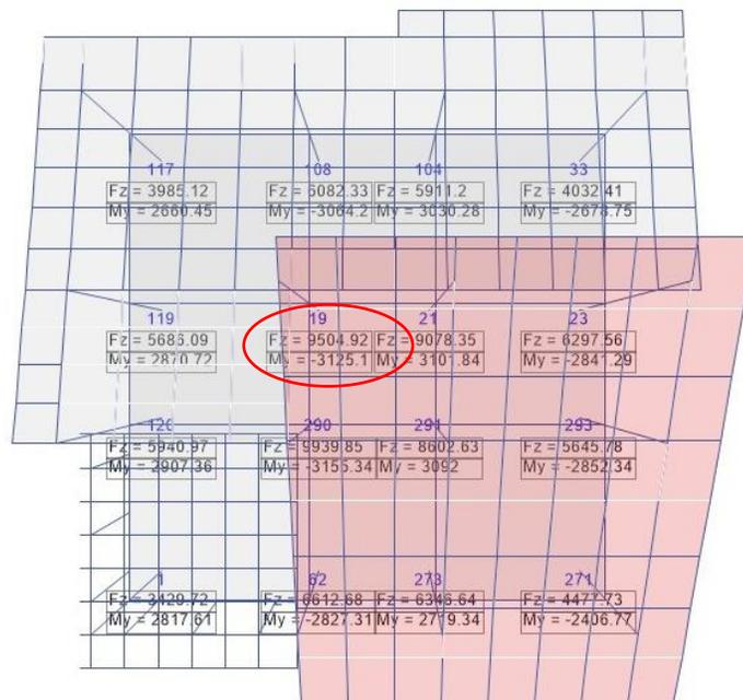
**Figura 185.** Cargas axiales de todas las columnas de la vivienda N°2
