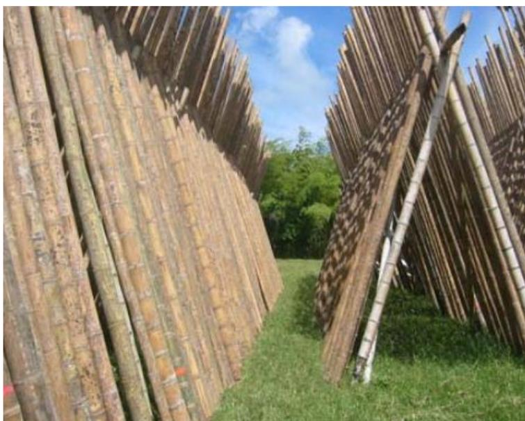
**Figura 35.** Secado al aire de los culmos en posición de tijeras.
