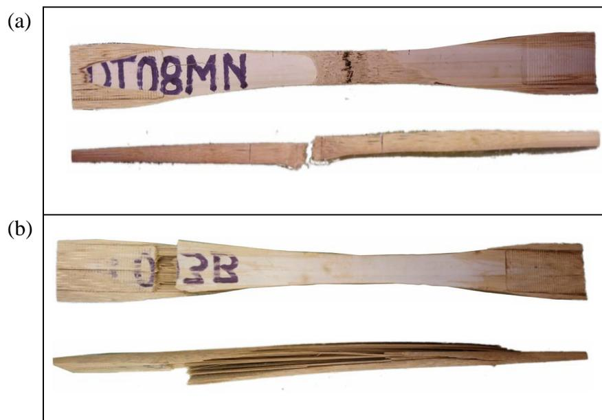
**Figura 71.** Tipos de falla en tracción (a) propagación de plasticidad con fractura progresiva en probetas nodales (DT08MN), y (b) desprendimiento paralelo a la fibra en probetas internodales (DT03B)
