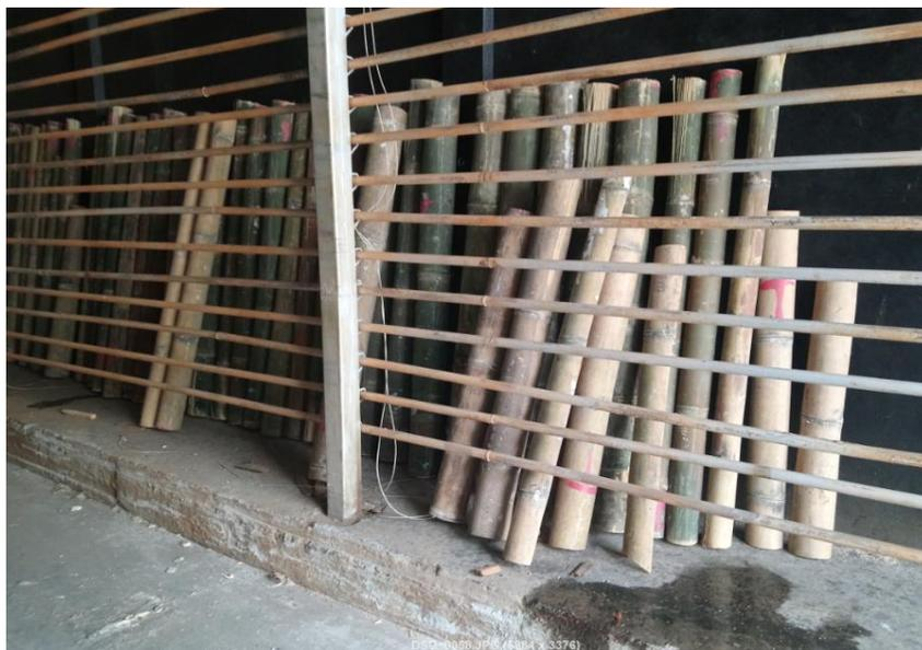
**Figura 36.** Culmos de *D. asper* secados en horno.
