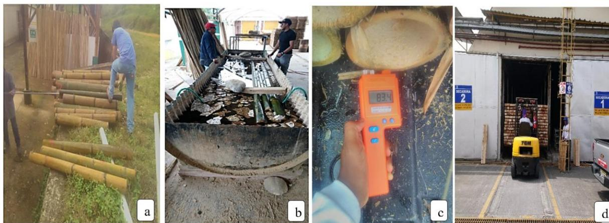
**Figura 39.** Procedimientos generales para el curado del *D. asper* (a) perforación de diafragmas, (b) proceso de sumersión en solución inmunizante, (c) lectura de temperatura previo al ingreso, e (d) ingreso a hornos de secado
