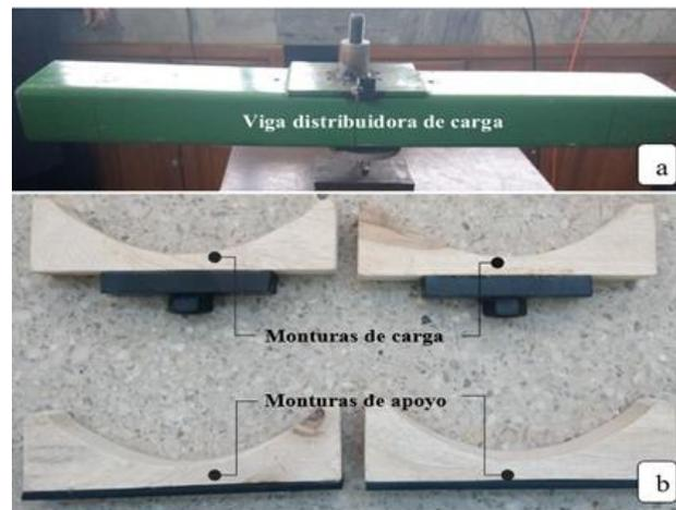
**Figura 55.** Aditamentos implementados en el ensayo de flexión (a) viga distribuidora de carga, y (b) monturas de carga y de apoyo
