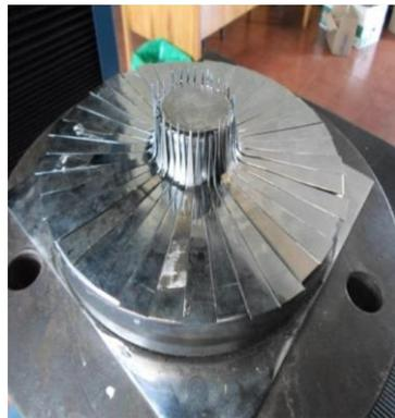
*Figura 47.* Pletinas de latón en configuración radial
