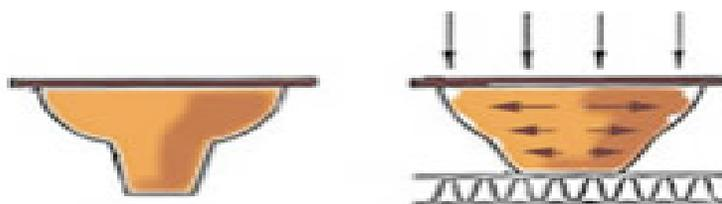
**Figura 17.** Comportamiento del cliché con dureza normal.
