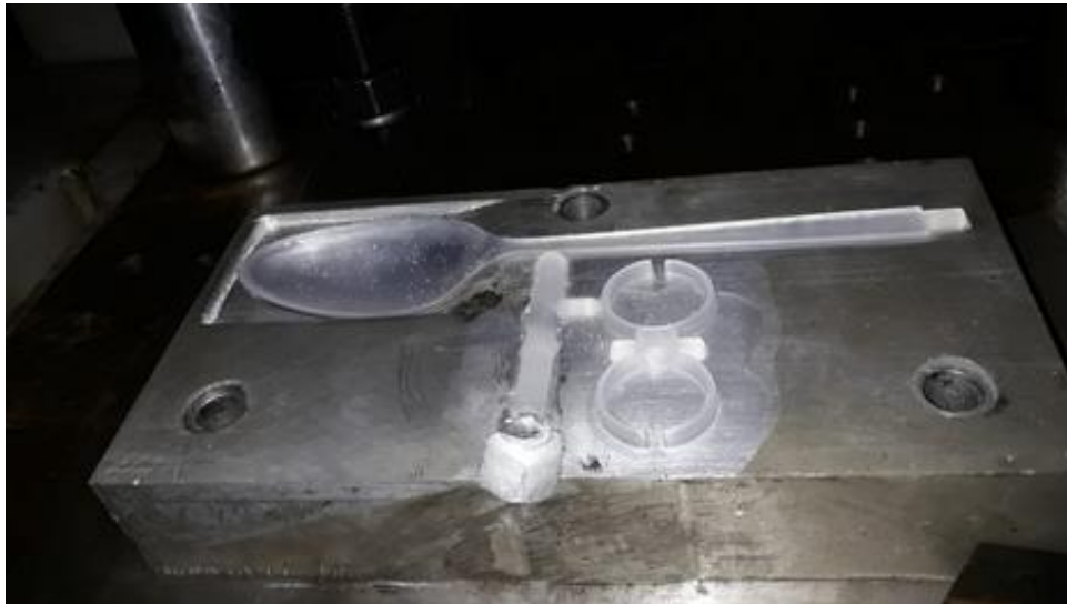
Figura 88. Desmoldeo de la cuchara
