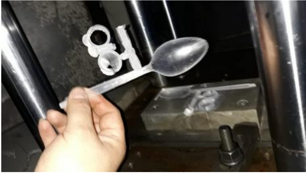
Figura 89. Cuchara obtenida por inyección de PLA
