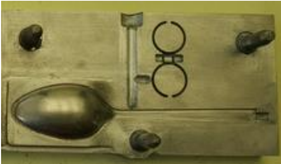
Figura 85. Molde – núcleo mecanizado
