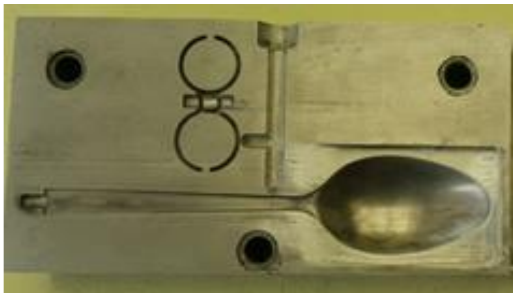
Figura 84. Molde - cavidad mecanizado
