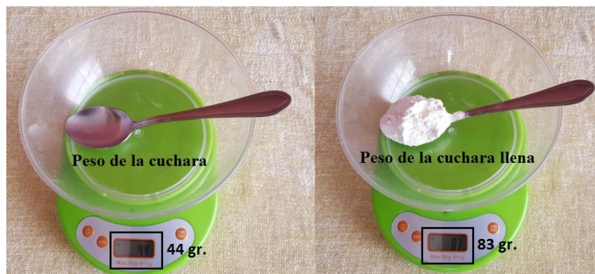
Figura 29. Datos recolectados de la carga real en una cuchara
