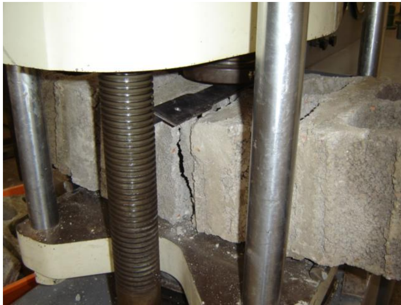
Figura 2.19: Falla la viga por ruptura del mampuesto.
