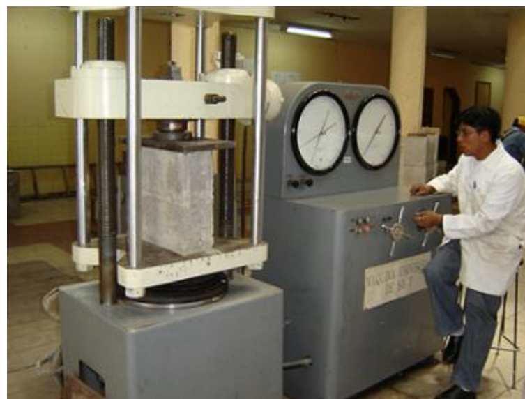
Figura 2.15: Ensayo de las pilas.
