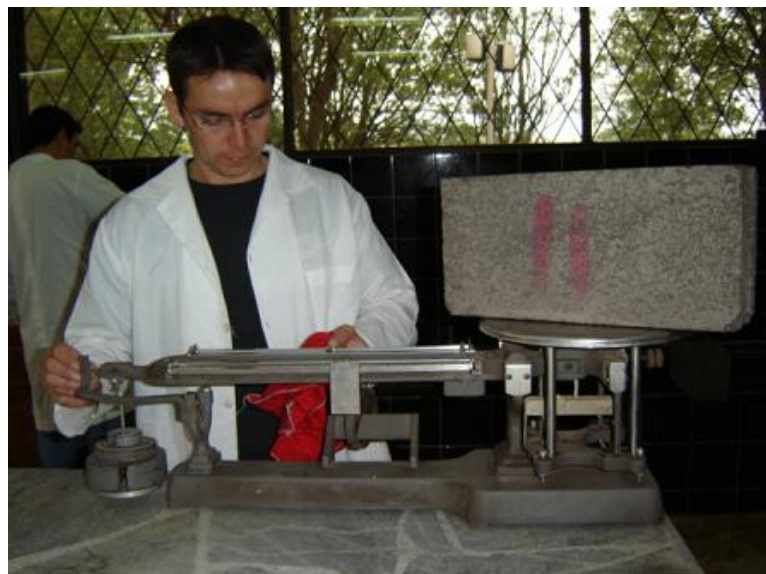
Figura 2.3: Toma del peso de los mampuestos
