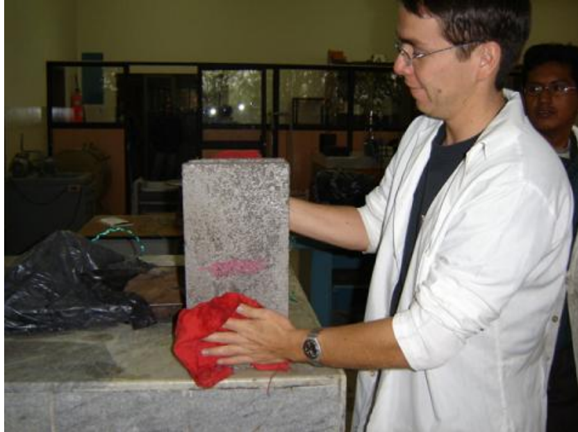
Figura 2.2: Secado de los mampuestos
