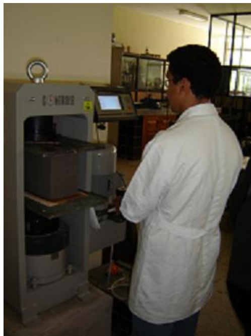
Figura 2.12: Colocación de la muestra en el equipo de compresión del bloque.
