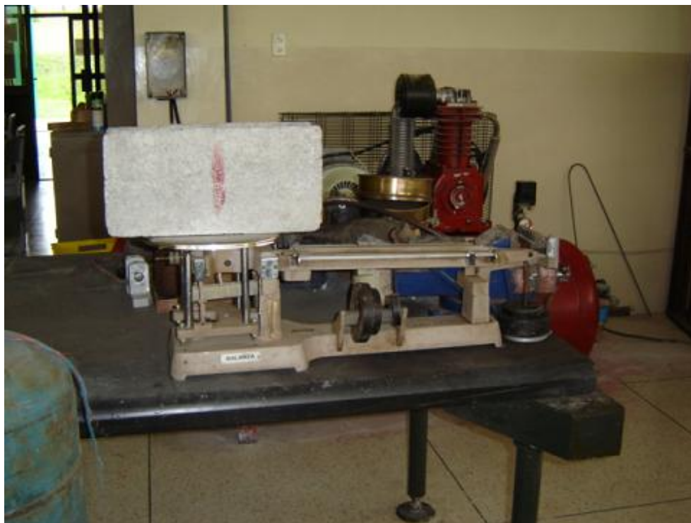
Figura 2.7: Peso de los mampuestos secos.
