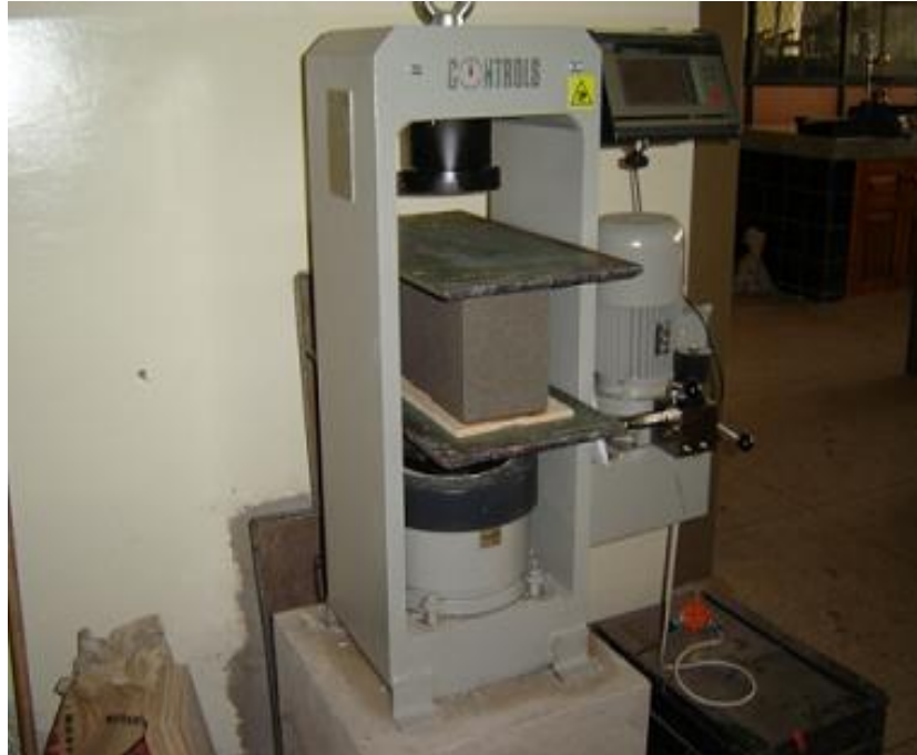
Figura 2.10: Maquina Digital para el ensayo de la resistencia a la compresión.
