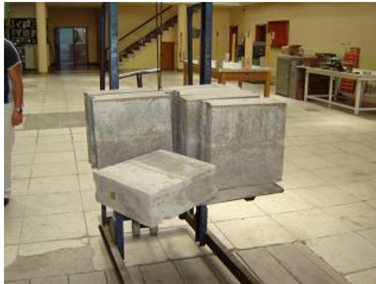
Figura 2.14: Pilas de Ensayo.
