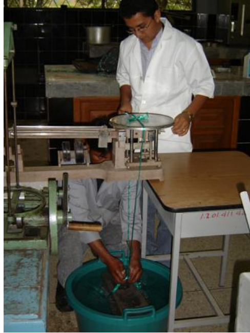
Figura 2.4: Mampuesto sumergido para la obtención del peso sumergido.
