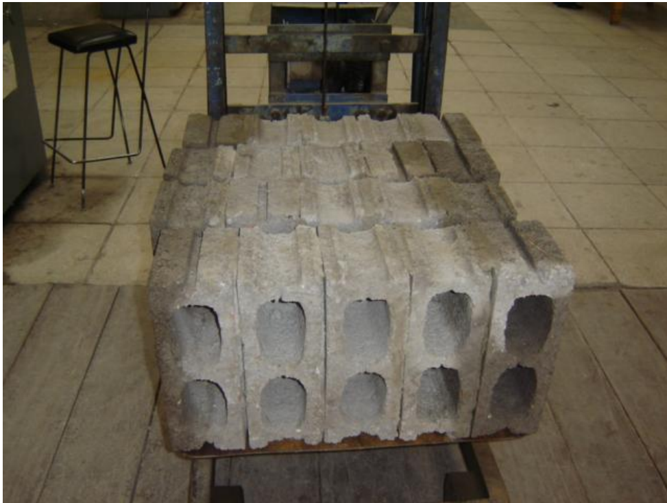
Figura 2.17: Vigas de mampuestos.
