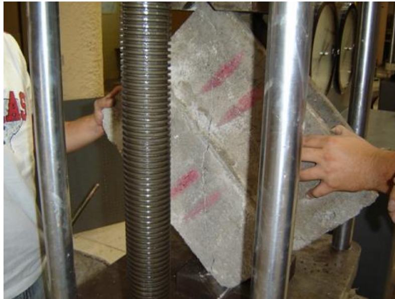
Figura 2.23: Forma de falla del murete una vez aplicada la carga.
