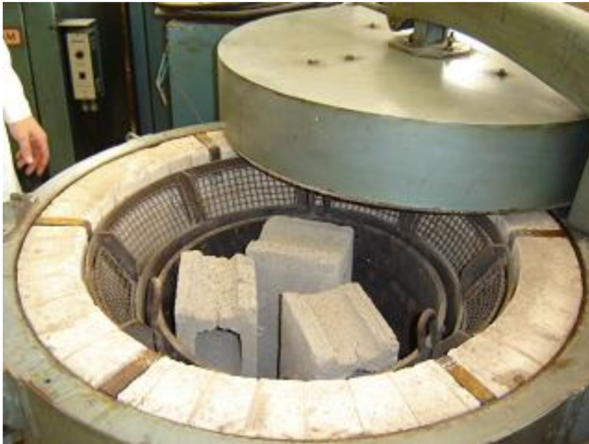
Figura 2.6: Mampuestos secos dentro del horno.
