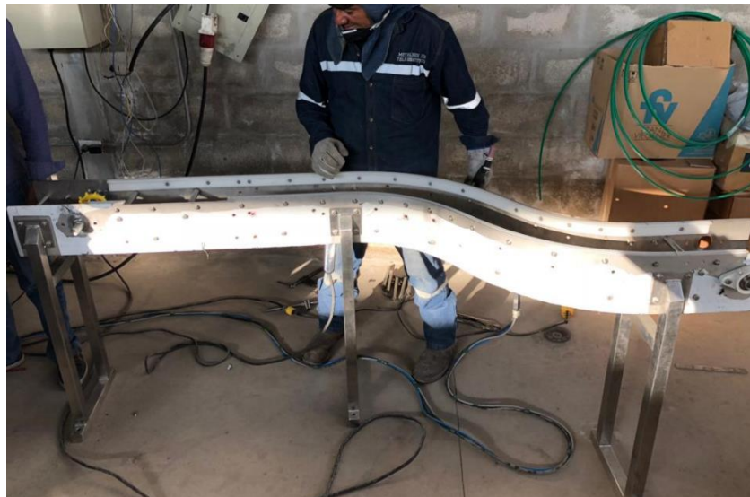
Figura 31. Soportes banda principal
