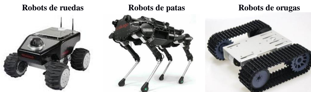
Figura 5. Tipos de locomoción de un robot móvil
