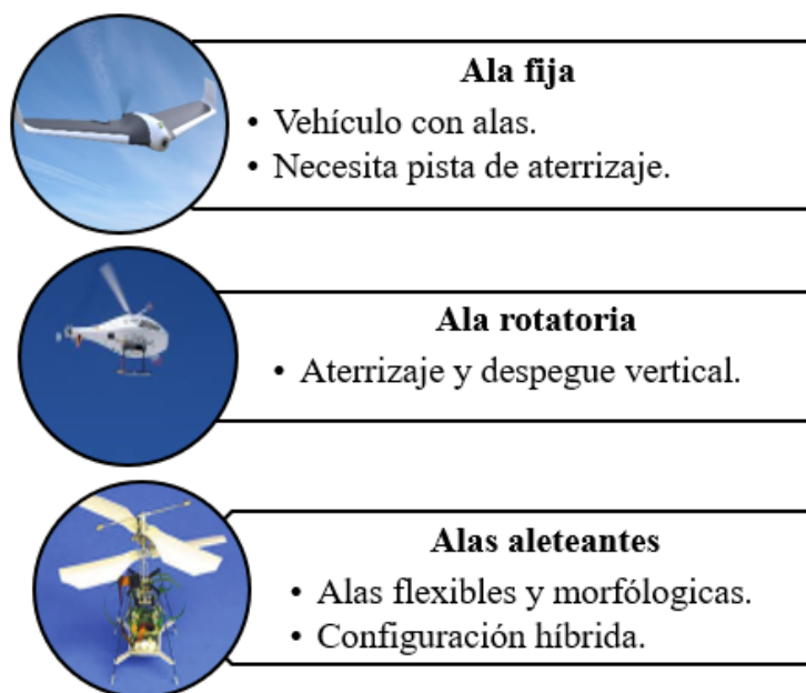
Figura 7. Clasificación de los UAV de acuerdo a su tipo de alas
