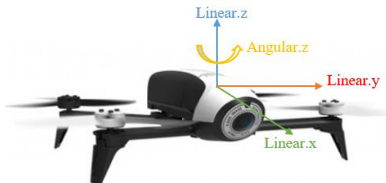
Figura 42. Esquema de coordenadas del UAV.
