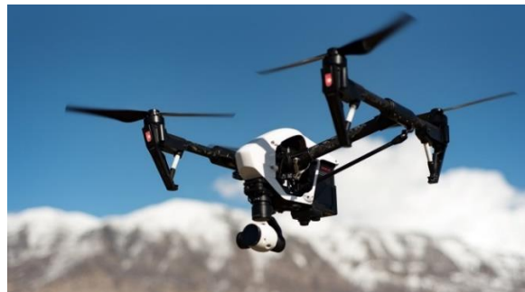
Figura 6. Ejemplo de UAV de cuatro rotores
