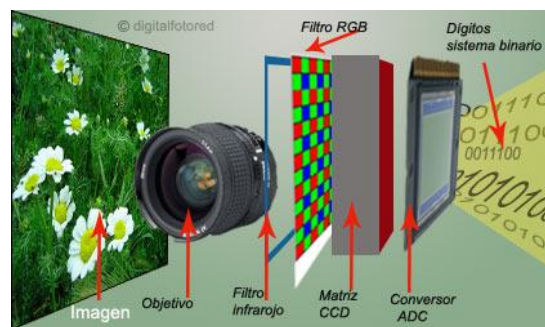
Figura 13. Proceso de formación de una imagen digital.
